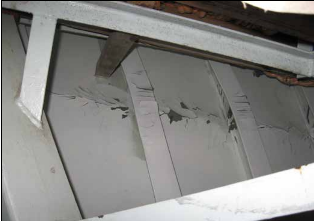
Abbildung 7: Beschädigung Vorsteven CORAL IVORY (Innenaufnahme)
