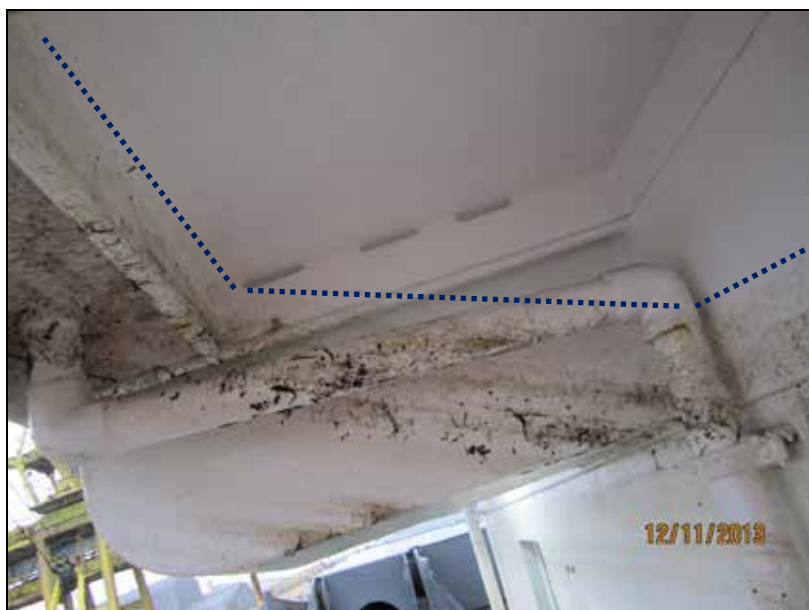
Abbildung 46: Grenze des maximalen Eintauchens der Backbordseite der SIDERFLY
