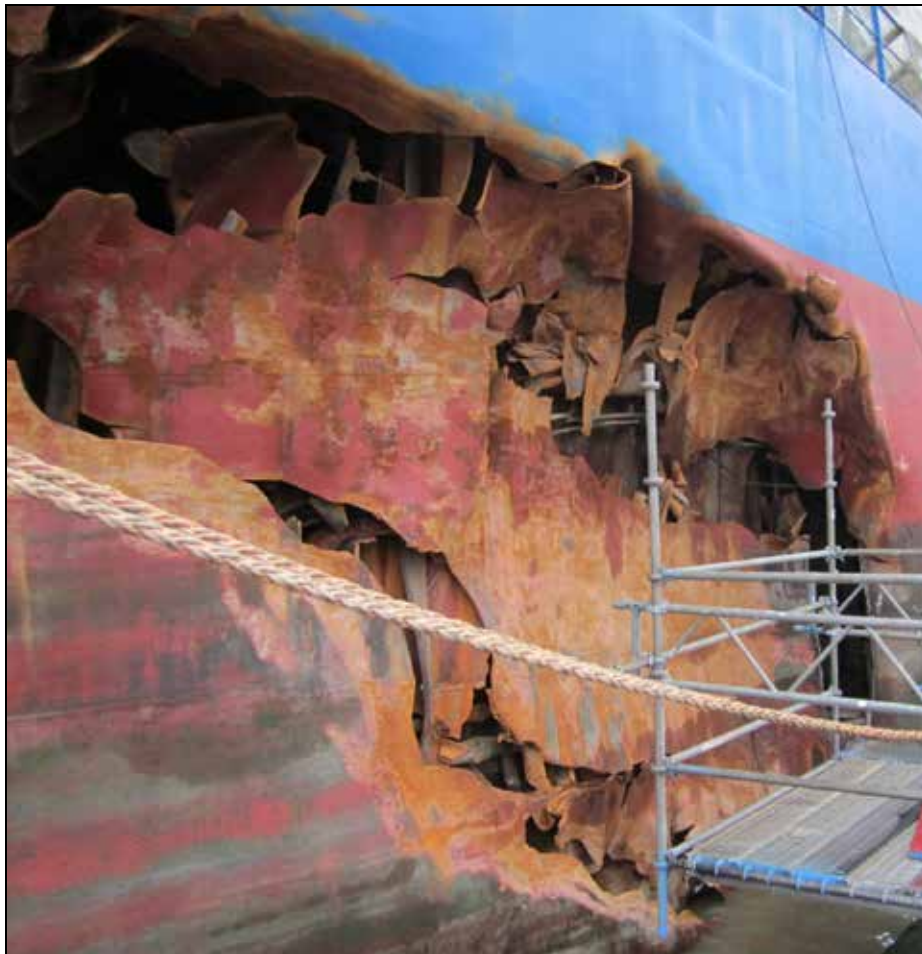
Abbildung 41: Loch in der Außenhaut der SIDERFLY (Backbordseite)
