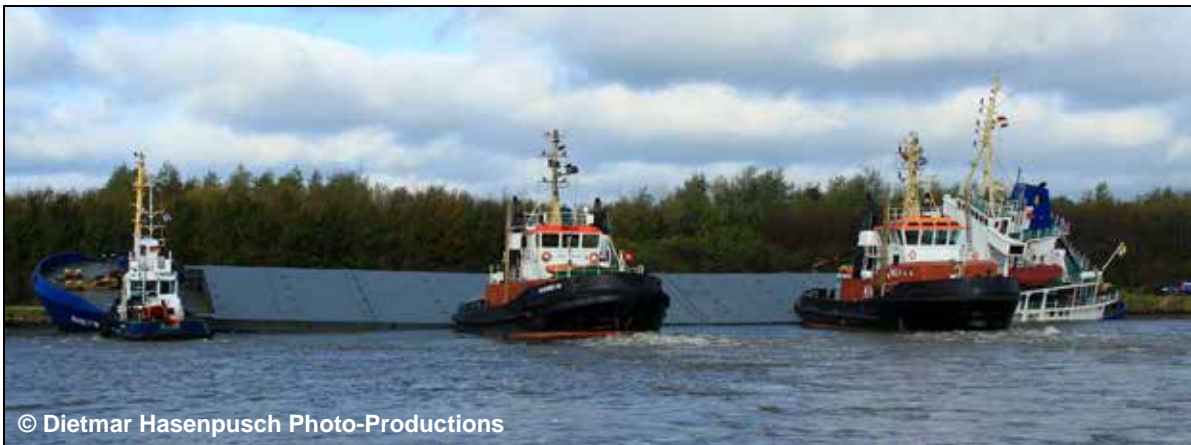
Abbildung 4: Stabilisierung der SIDERFLY an der Kanalböschung
