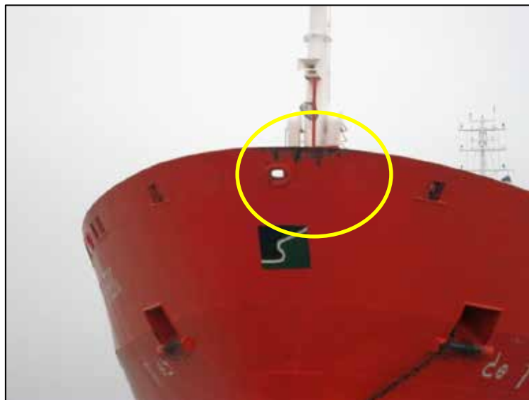
Abbildung 5: STENBERG - geringer Schaden am Bug
