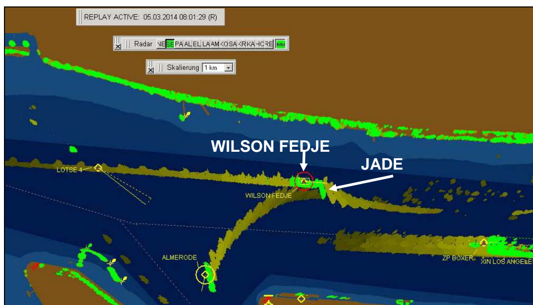
Abbildung 15: Radar-/AIS-Aufzeichnung der Nautischen Zentrale (08:01:29 Uhr) (Kollisionszeitpunkt)
