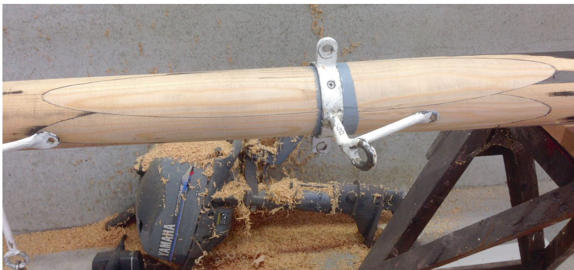
Abbildung 19: Reparatur einer von Holzfäule befallenen Stelle. Quelle: Jachtwerf fa. M. van Duivendijk.
