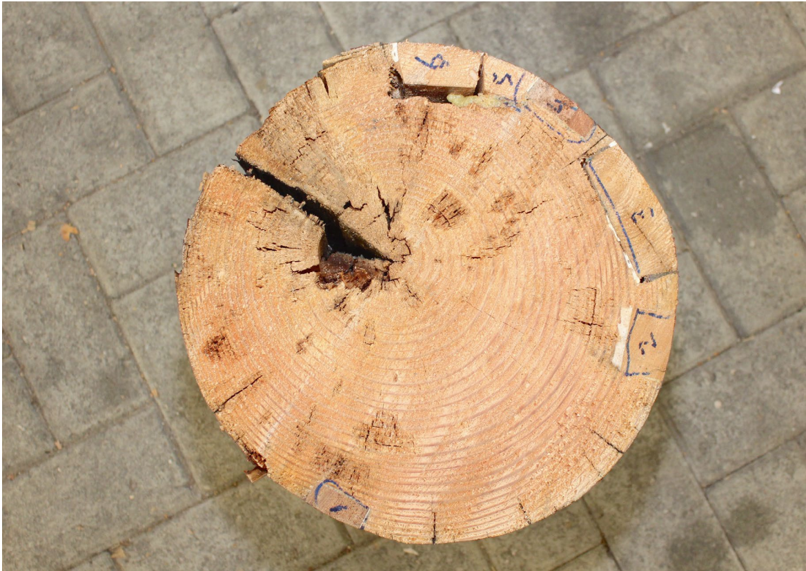
Abbildung 43: Querschnitt in der Nähe der Bruchstelle. Foto: Untersuchungsrat für Sicherheit
