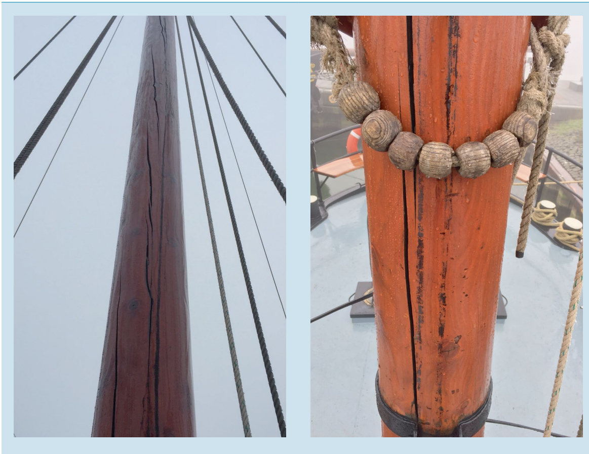
Abbildung 17: Holzmast mit Windrisse. Quelle: Untersuchungsrat für Sicherheit.
