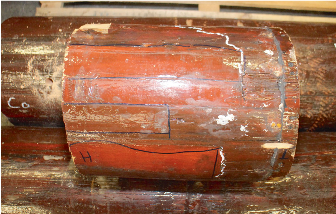
Abbildung 45: Seitenansicht der eingeklebten Leisten. Foto: Untersuchungsrat für Sicherheit
