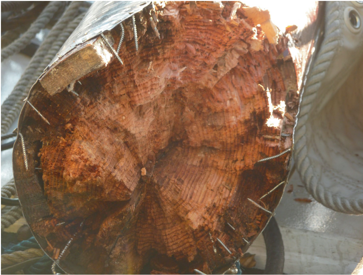
Abbildung 6: Bruchstelle und Zersetzungsspuren. Quelle: Untersuchungsrat für Sicherheit
