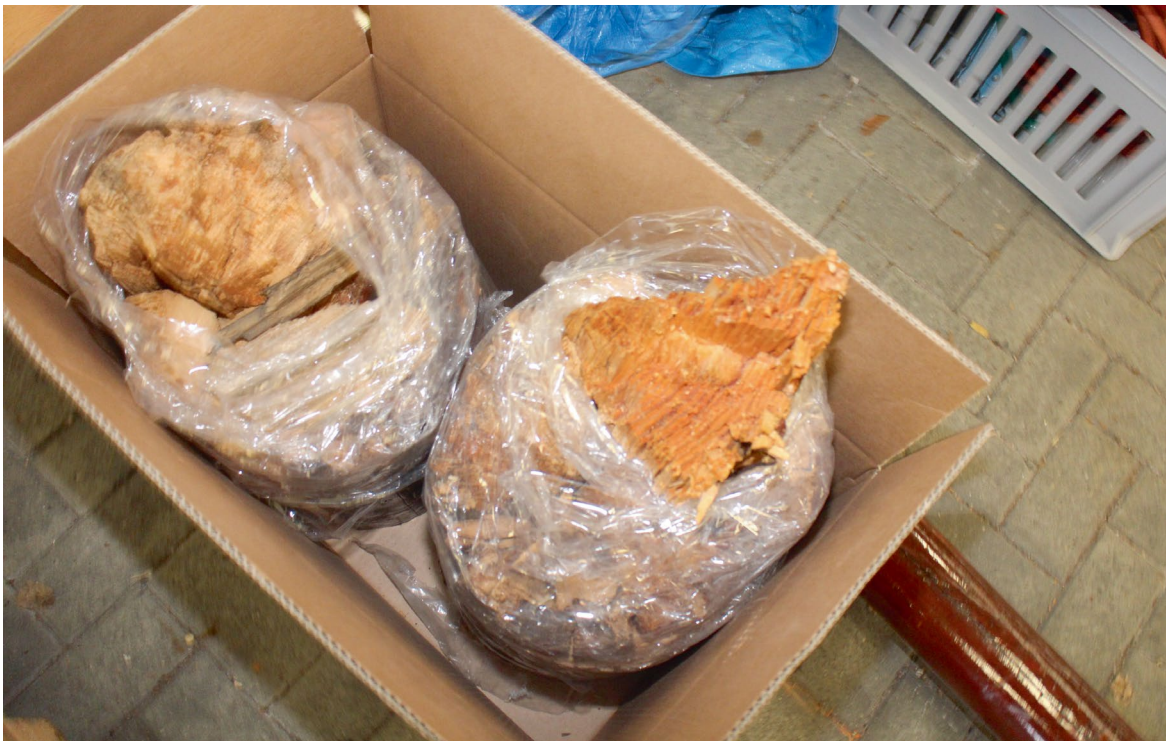
Abbildung 40: Bruchstelle mit zersetztem Holz. Foto: Untersuchungsrat für Sicherheit
