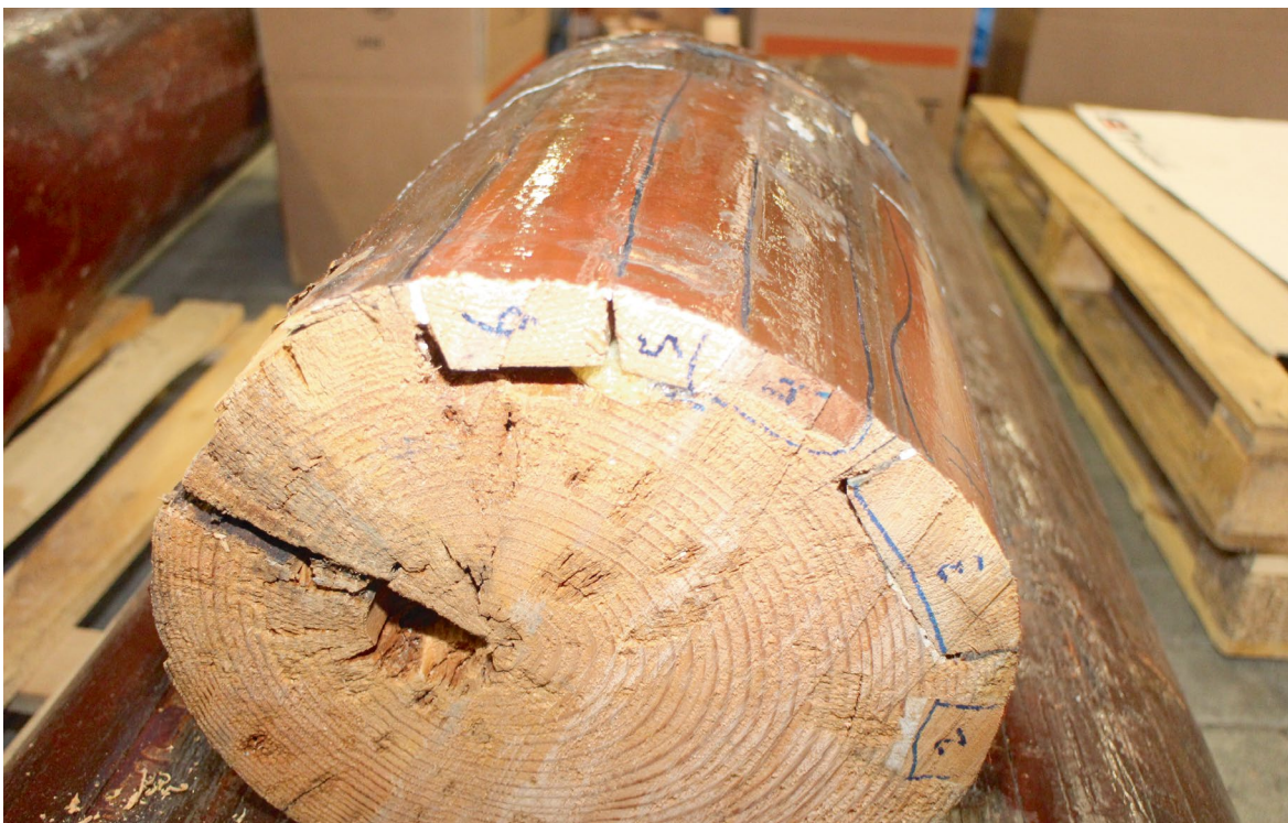
Abbildung 44: Querschnitt mit eingeklebten Leisten. Foto: Untersuchungsrat für Sicherheit
