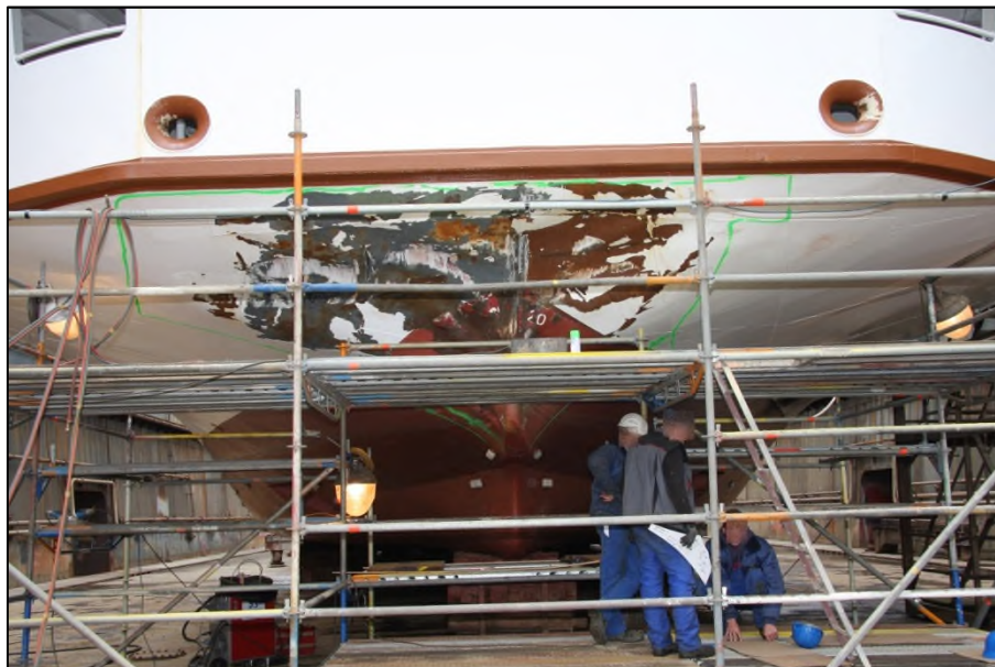
Abbildung 15: Schaden im Bugbereich der Fähre, Frontansicht
