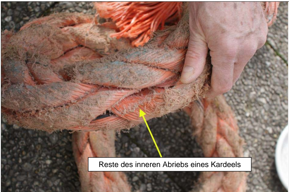
Abbildung 14: Innenstrangabrieb durch regelmäßige Abnutzung
