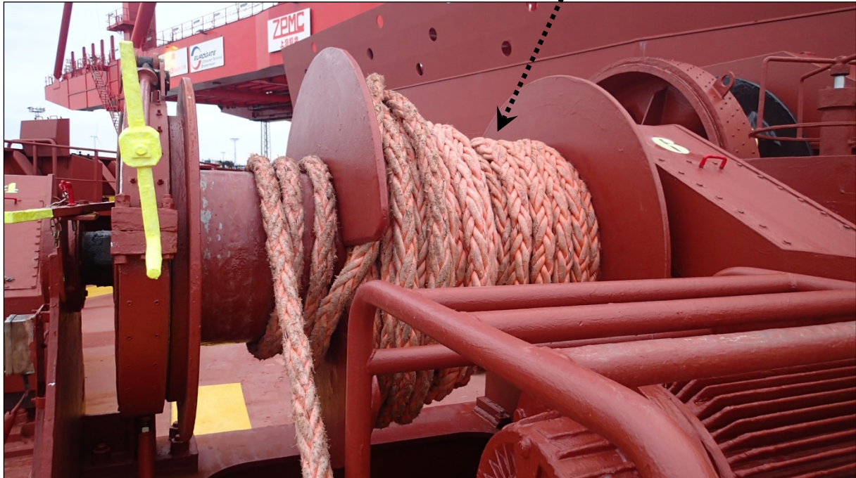
Abbildung 8: Winde der gerissenen Leine
