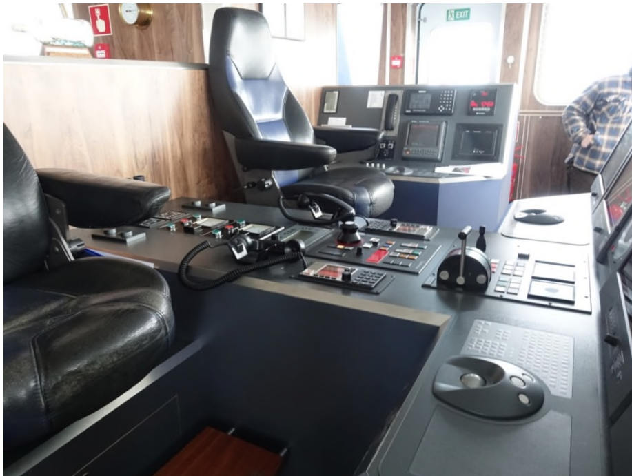
Abbildung 28: Steuerpult mit Kommandopositionen (Conning)
