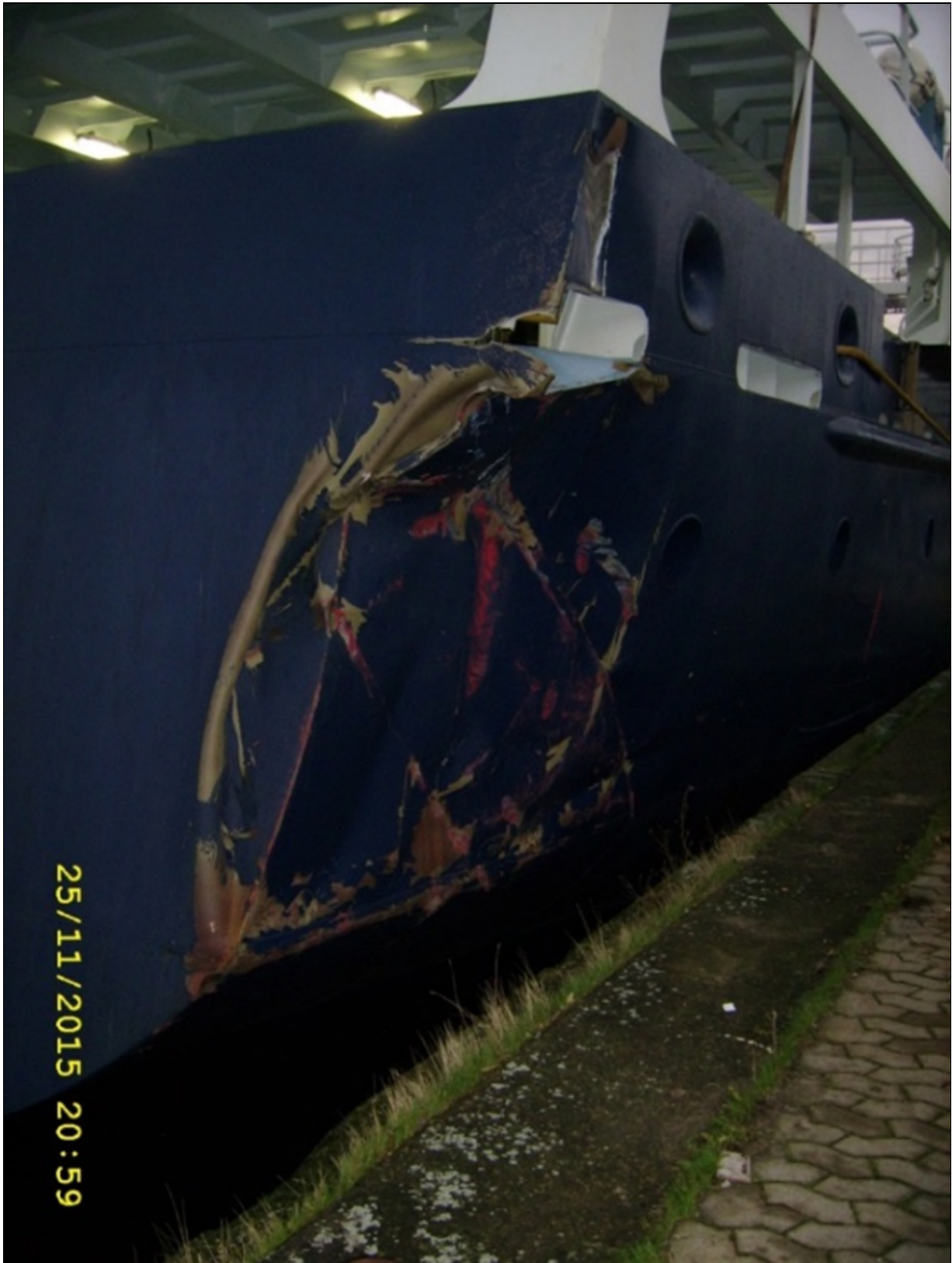
Abbildung 5: EENDRACHT, Schäden hinten, BG Verkehr
