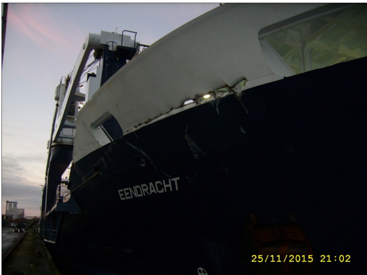
Abbildung 4: EENDRACHT, Schäden vorne, BG Verkehr
