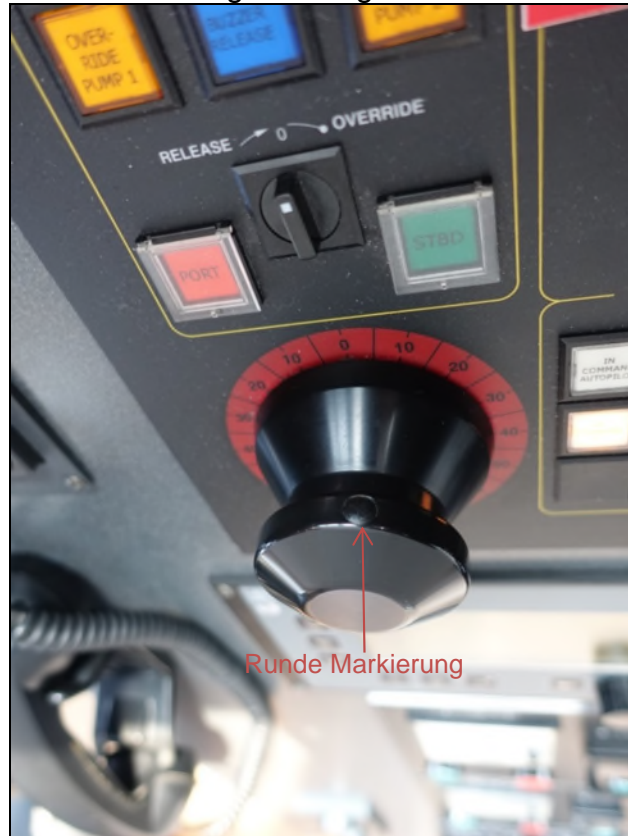
Abbildung 30: Handruder mit Rasterung mittschiffs (0)
