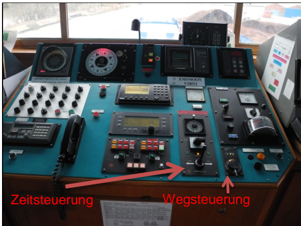
Abbildung 7: Weg- und Zeitsteuerung mit Tiller
