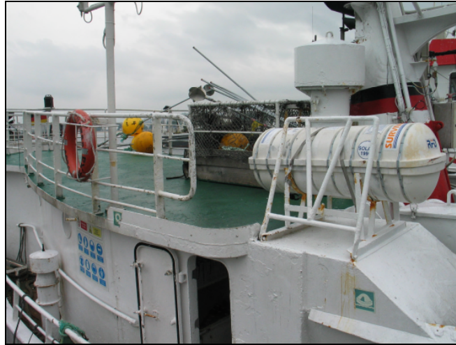
Abbildung 3: Fehlende Relling im Bereich des Peildecks
