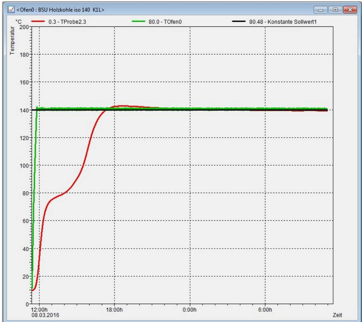
Fig. 4 : Testergebnis für UN N.4 Test mit indonesischer Holzkohle im 1 Liter Kubus
