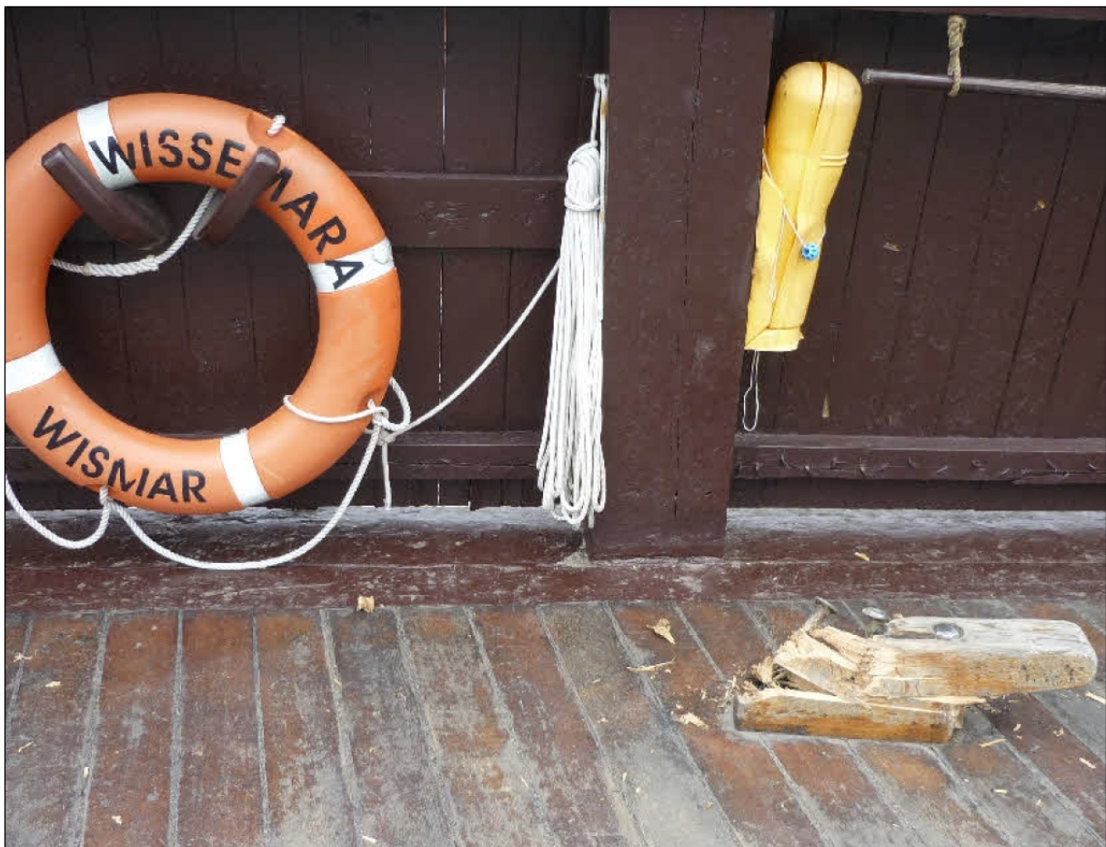
Abbildung 6: zerstörte Holzklampe (Seitenansicht)
