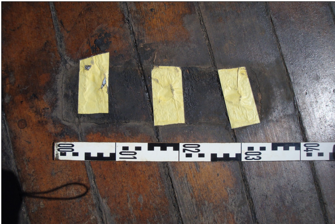
Abbildung 8: Holzplanken unter der zerstörten Klampe
