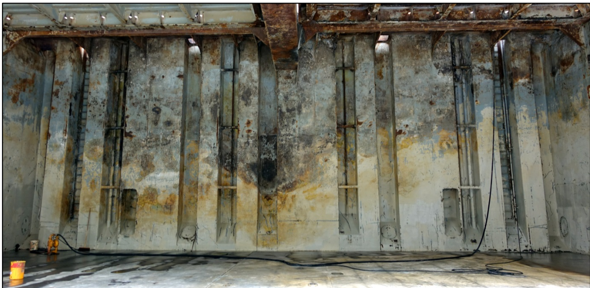
Abbildung 42: Unterraum Laderaum 3, achters Querschott Intensive Hitzespuren am achteren Querschott in einer Höhe ab 2,2 m.
