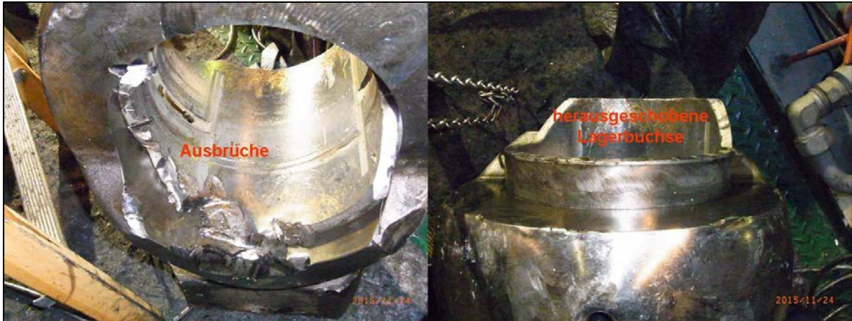
Abbildung 13: Pleuelauge mit Ausbrüchen und seitlich verschobener Lagerbuchse
