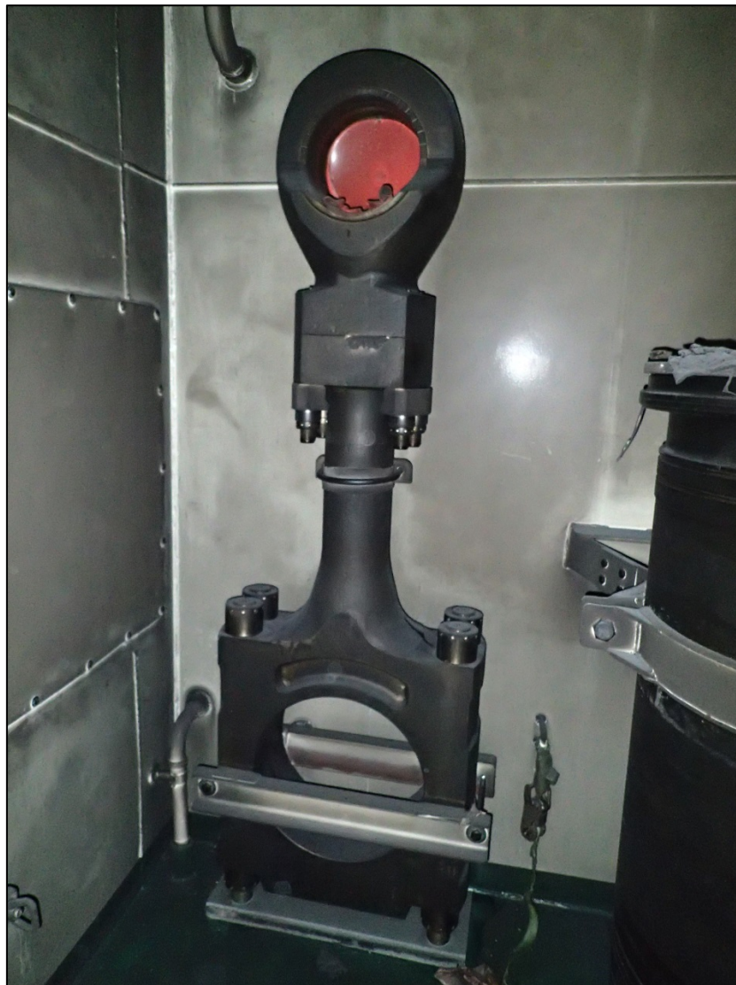
Abbildung 9: Ersatz-Pleuelstange im Maschinenraum der THETIS D
