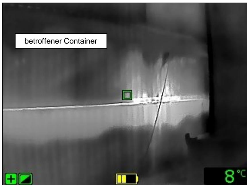
Abbildung 15: Temperaturmessung der Feuerweh auf der Stb-Seite des Stapels: 8 °C
