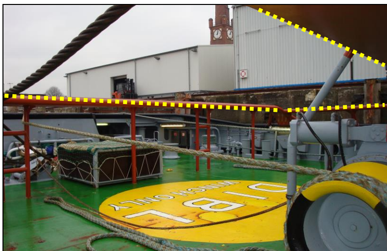
Abbildung 5: Begrenzung der Winschfläche durch stählerne Querstreben (Teilansicht)
