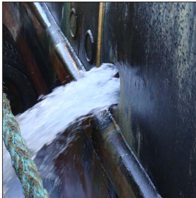
**Abbildung 5: Austritt Kühlwasser (in diesem Fall auf der Backbordseite der JAN MARIA)**
