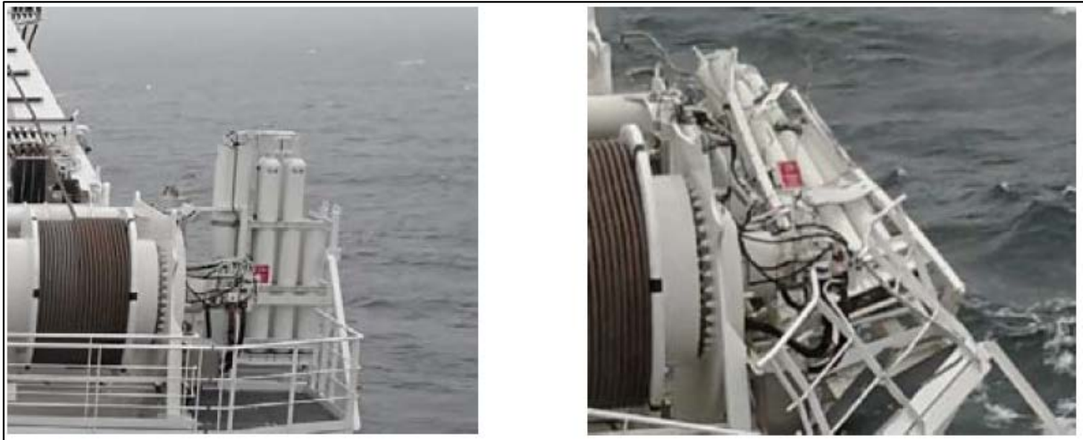
Abbildung 12: Bordkran – vor und nach dem Kontakt
