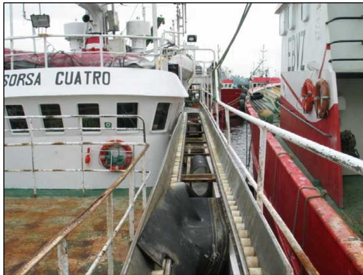
Abbildung 13: Ablaufbahn für die Korbreusen
