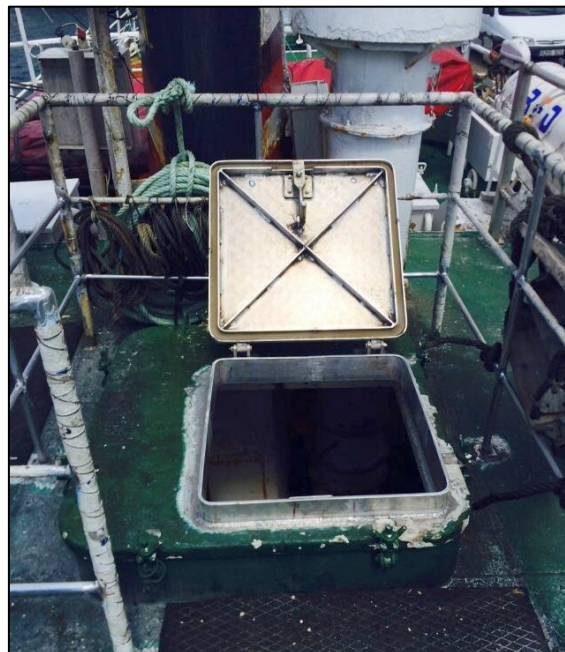
Abbildung 23: Neue Zugangsmöglichkeit zum Peildeck
