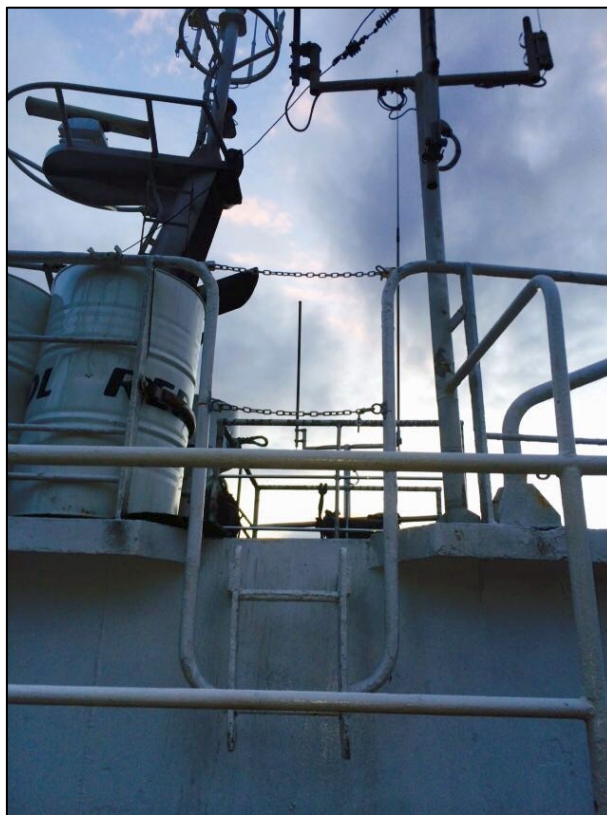
Abbildung 25: Leiter zum Peildeck mit Sicherungsketten
