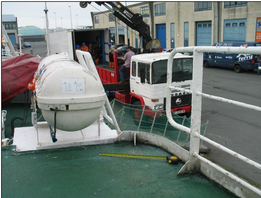
Abbildung 21: Ungesicherter Bereich neben dem Rettungsfloß
