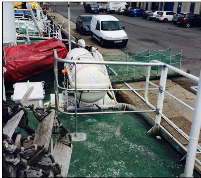
Abbildung 22: Zusätzliche Reling im Bereich des Rettungsfloßes
