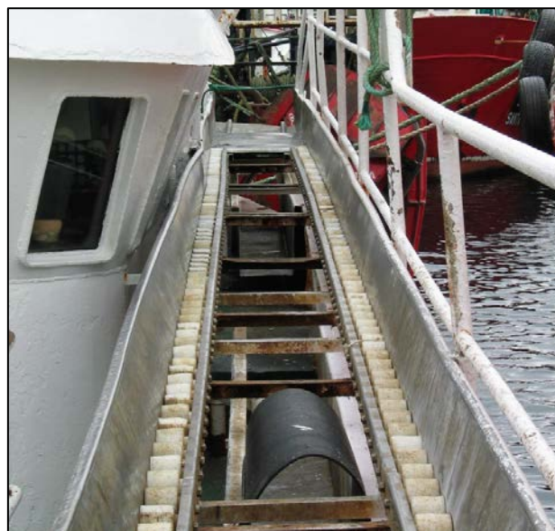
Abbildung 14: Ablaufbahn, Detailaufnahme mit Rollen und Querstreben, Blick nach achtern
