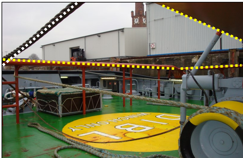
Abbildung 35: Begrenzung der Winschfläche durch stählerne Schleppbügel und Schleppseil (Teilansicht)
