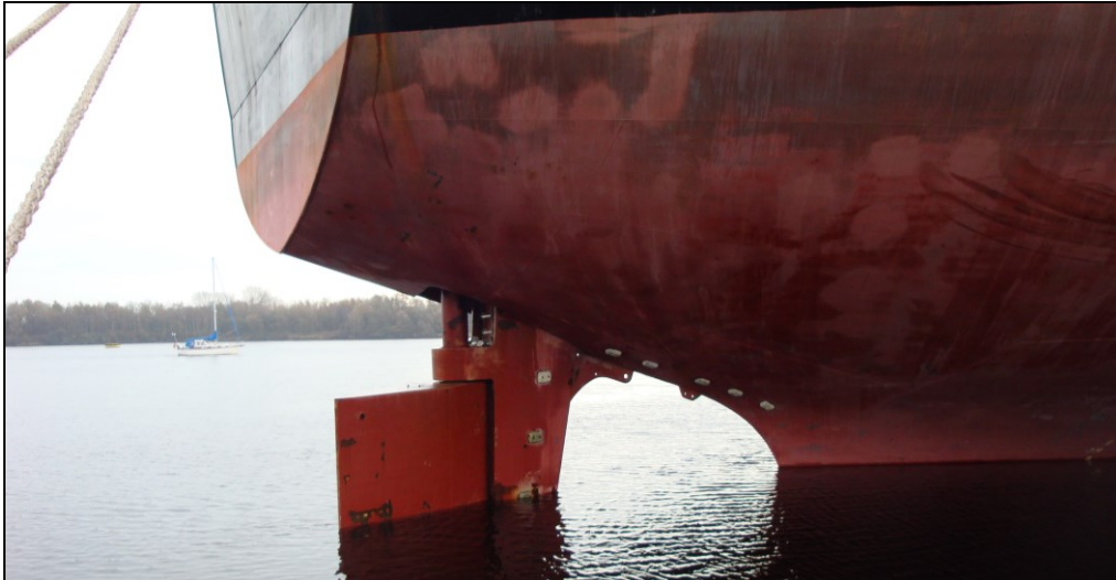
Abbildung 12: Ruderblatt der GLORY AMSTERDAM (Beschädigungen optisch nicht erkennbar)
