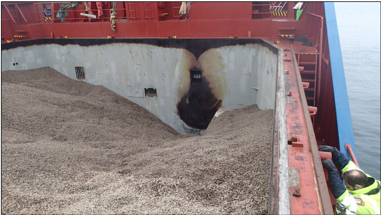
Abbildung 7: Verrußter Bereich oberhalb der Ladung und Hotspot am Wing Tank
