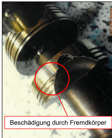
Abbildung 55: Beschädigung am Kolben des Proportionalventils 38
