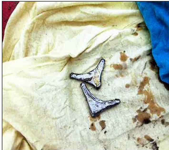
Abbildung 42: Aufgefundene Bruchstücke des Abstützbleches 33
