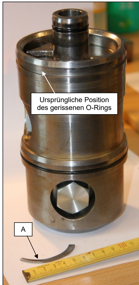
Abbildung 45: Ventilaufnahme und entfernter Fremdkörper (A) 34
