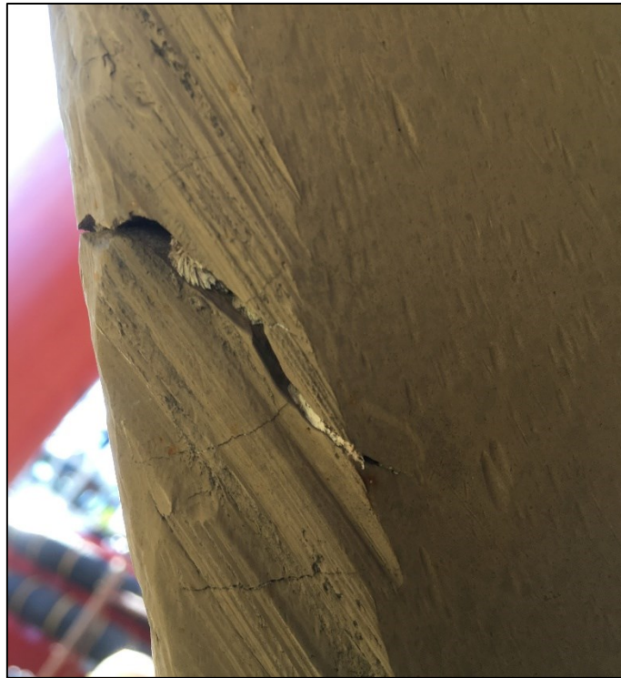
Abbildung 38: Einriss an einem der Propellerflügel Im Einriss wurden Reste von Tauwerk gefunden.
