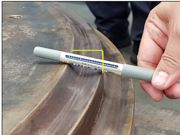
Abbildung 52: Materialabtrag am Abdeckflansch Ursprünglicher Zustand des Bauteils in Gelb markiert.
