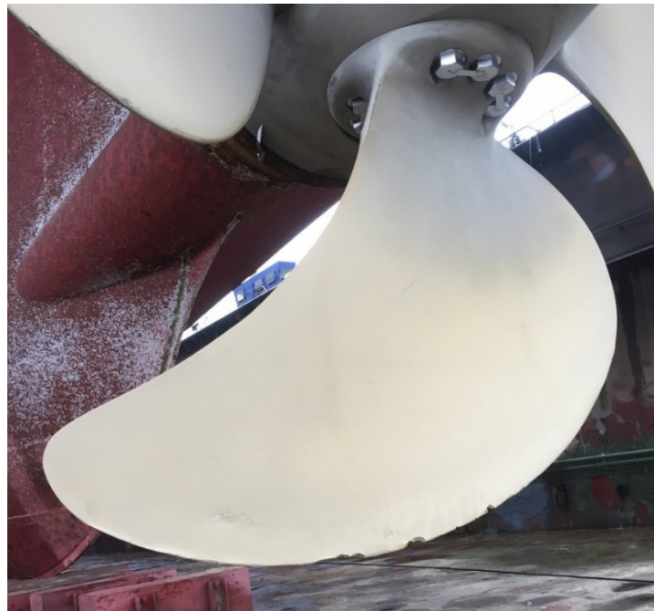
Abbildung 36: Beschädigungen an einem der Propellerflügel
