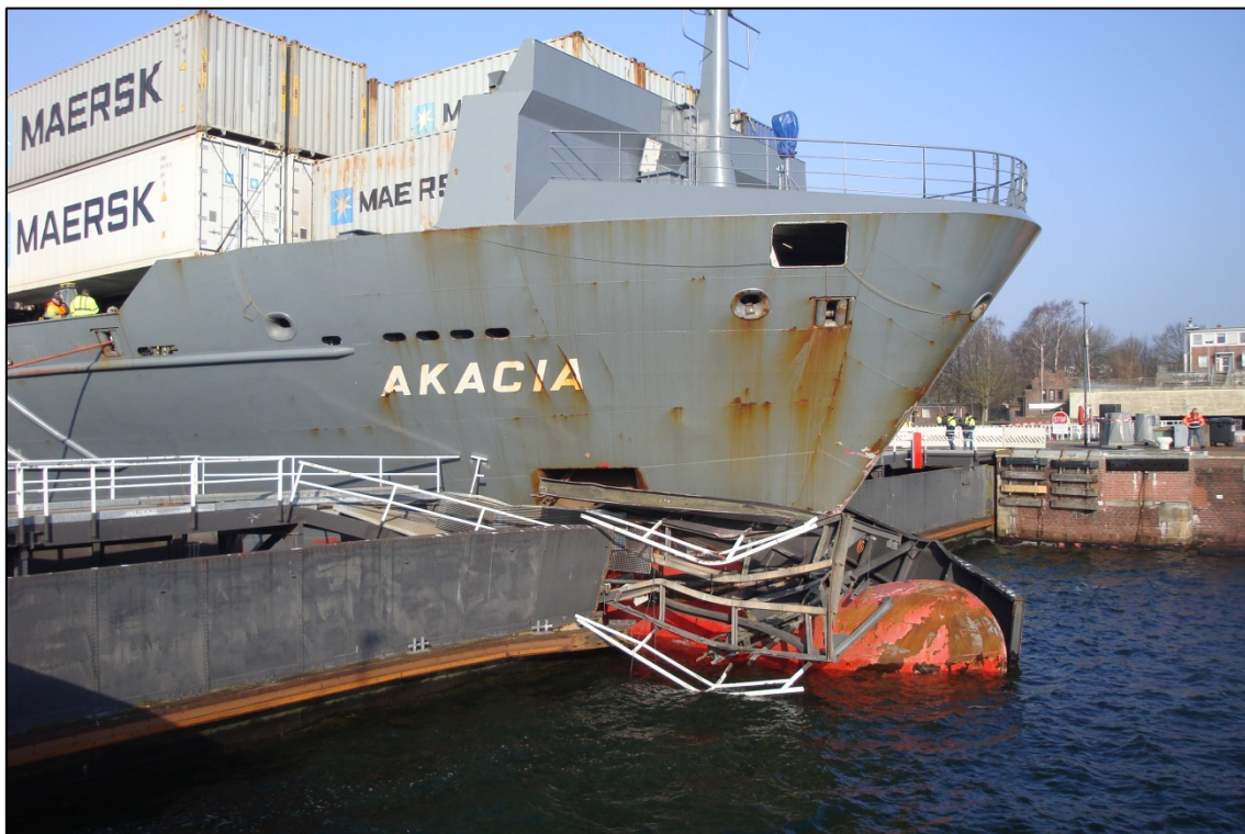
Abbildung 4: Die AKACIA und das durchbrochene Schleusentor
