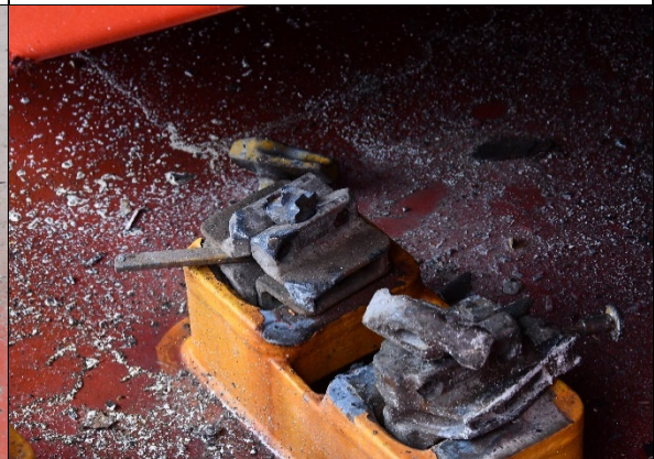
Abbildung 18: Defektes Twistlock (Quelle: Wasserschutzpolizei BHV)
