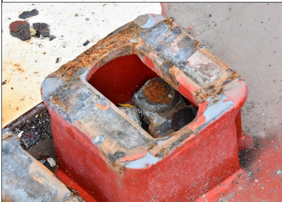
Abbildung 15: Defektes Twistlock an einem verbogenen Decksbeschlag (Quelle: Wasserschutzpolizei BHV)
