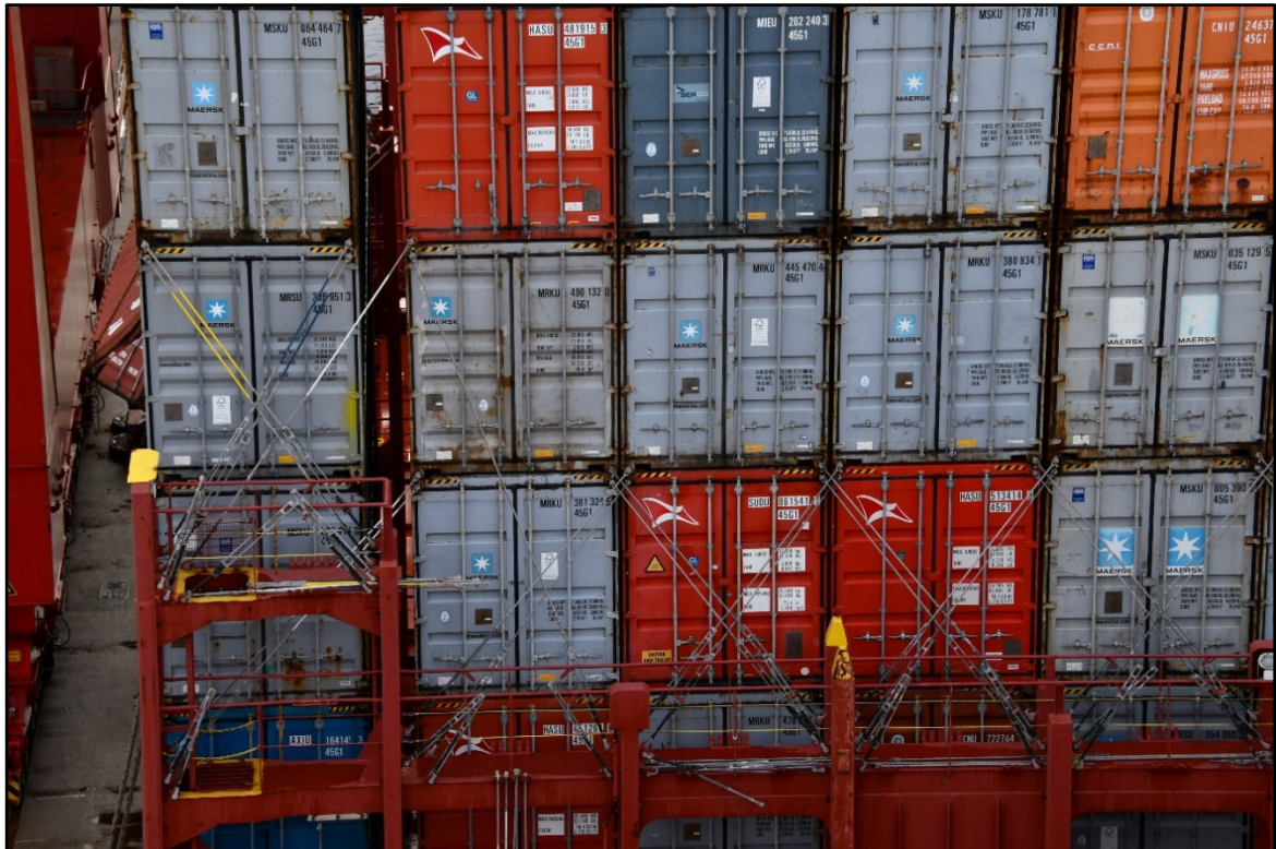
Abbildung 26: Laschbrücke der MSC ZOE (Quelle: DSB)
