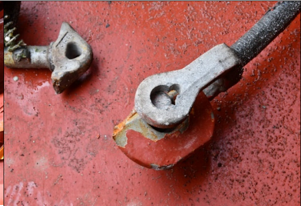
Abbildung 14: Defekte Befestigung der Laschbrücke (Quelle: Wasserschutzpolizei BHV)
