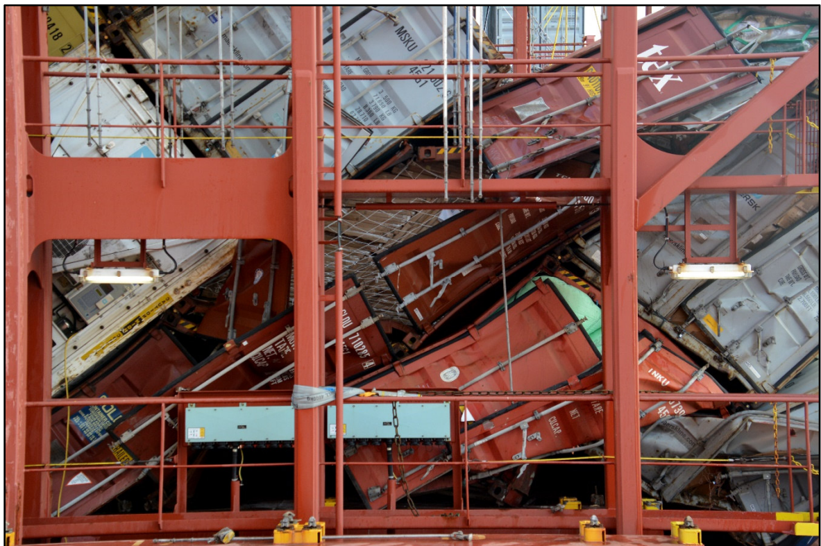
Abbildung 6: Zerquetschte Container an Bord der MSC ZOE. (Quelle: DSB)
