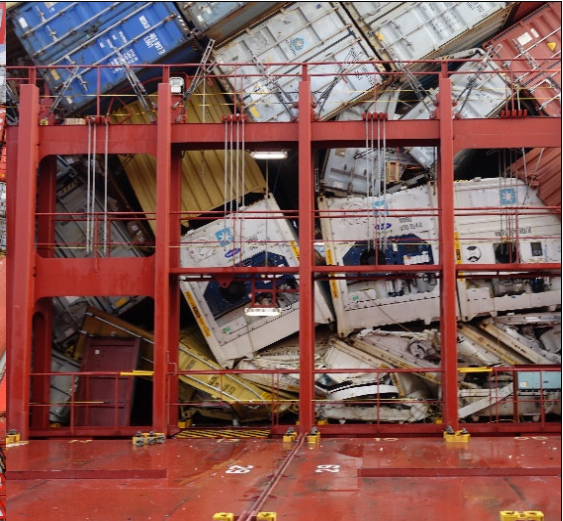
Abbildung 8: Zusammengestürzte Container in Bay 26. (Quelle: BSU)
