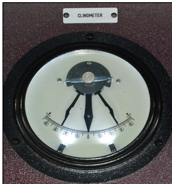
Abbildung 48: Foto des Inklinometers auf der Brücke der MSC ZOE nach dem Containerverlust
