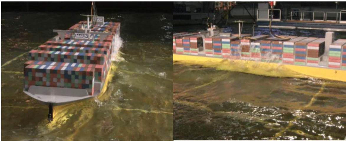
Abbildung 52: Bilder des Schiffsmodells und Grünes-Wasser-Effekte (Quelle: MARIN)
