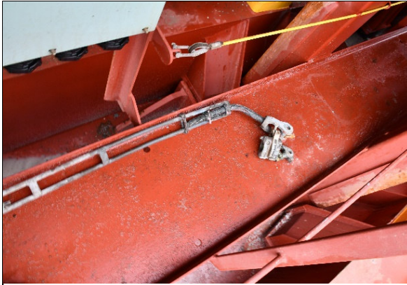
Abbildung 13: Verbogener Wantenspanner (Quelle: Wasserschutzpolizei BHV)
