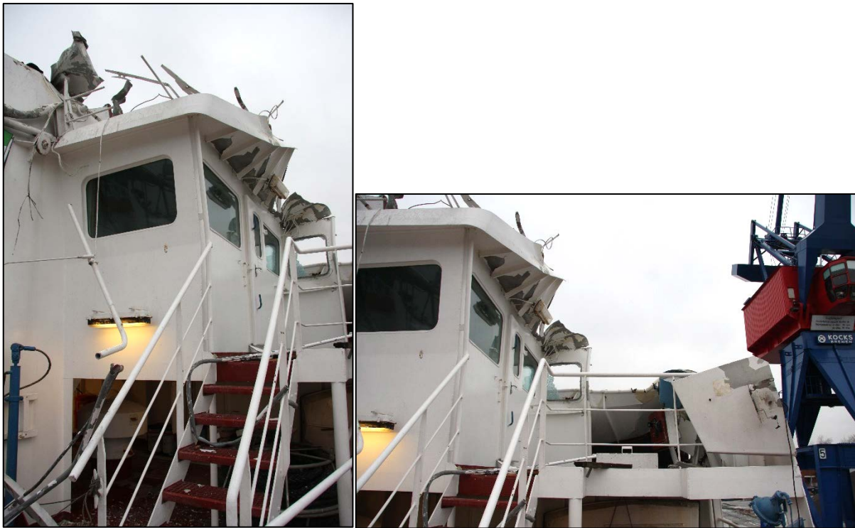
Abbildung 28: Beschädigte Steuerbord-Nock der EVERT PRAHM
