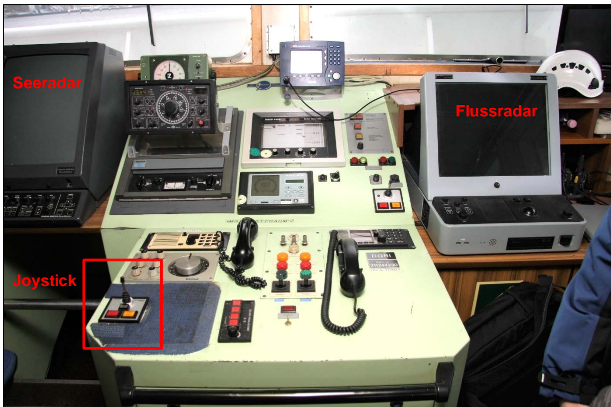
Abbildung 25: Fahrstand der EVERT PRAHM, Joystick-Steuerung, aufgenommen am 08.01.2016
