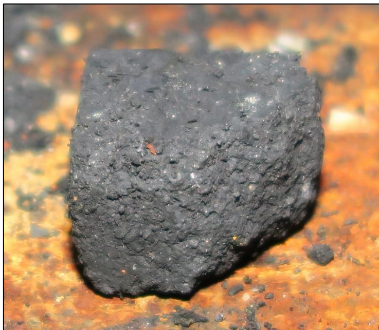
Abbildung 33: Nahaufnahme eines Kokosnuss-Kohlewürfels
