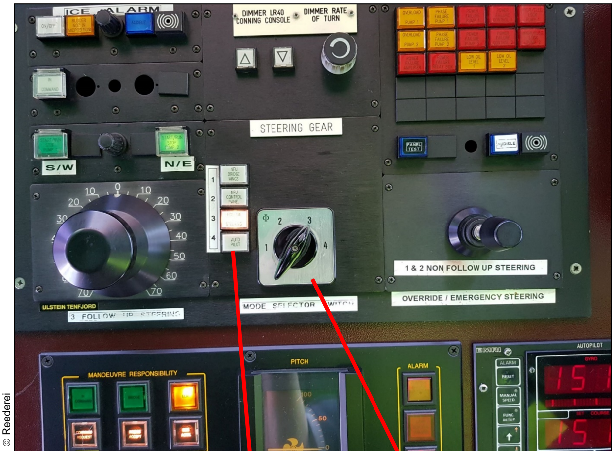
Abbildung 3: Bedienfeld für Ruderanlage
