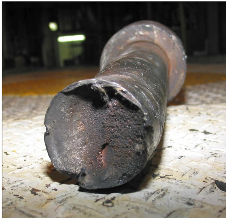
Abbildung 15: Nahansicht der Bruchfläche der Turboladerwelle
