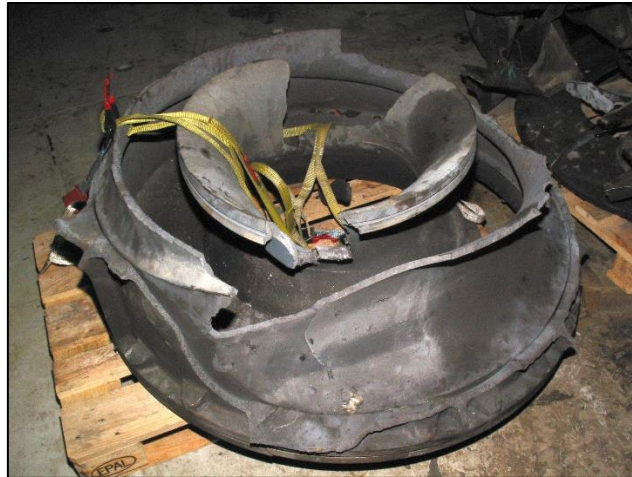
Abbildung 21: Verdichtergehäuse mit Einströmgehäuse 15
