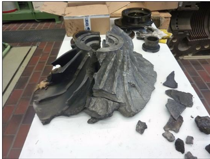
Abbildung 29: Gebrochene Verdichterschaufeln nahezu ohne Verformung
