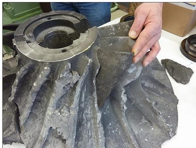
Abbildung 28: Verformte und gebrochene Verdichterschaufeln mit Materialverschmierung
