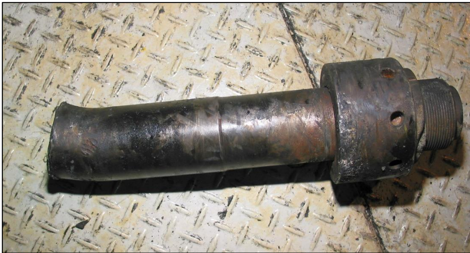
Abbildung 14: Turboladerwelle mit Hydraulikmutter
