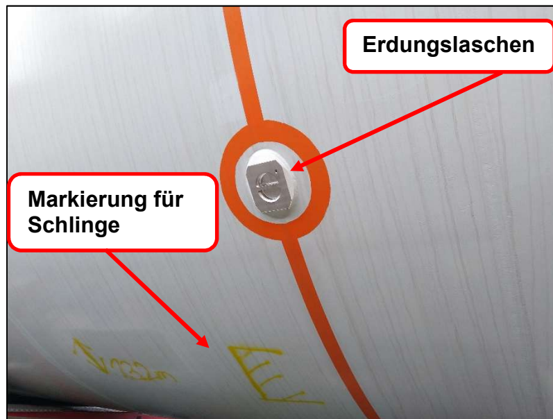
Abbildung 16: Lage Hebeschlingen und Erdungslasche (andere Hieve)
