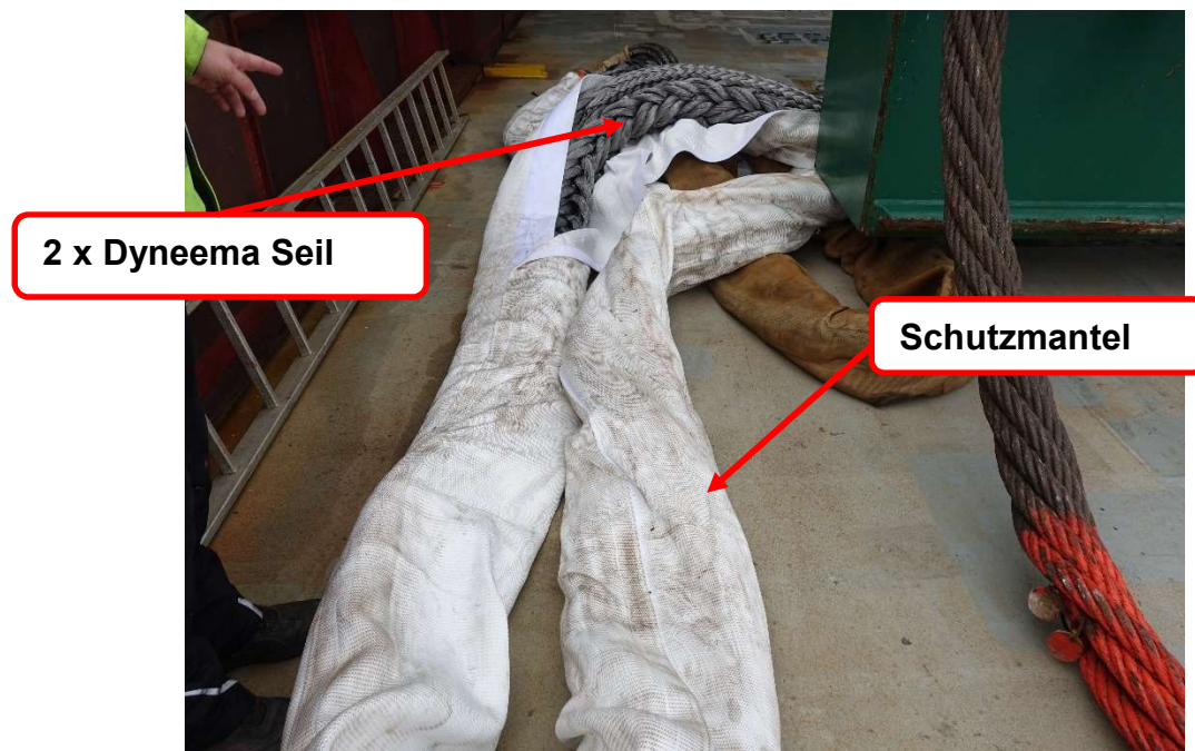
Abbildung 15: Hebeschlinge vom Konischen Teil des MP
