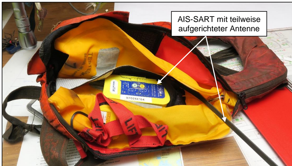
Abbildung 23: Arbeitssicherheitsweste mit integrierter AIS-SART
