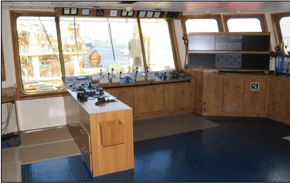
Abbildung 4: Windenfahrstand an der Achterkante der Brücke
