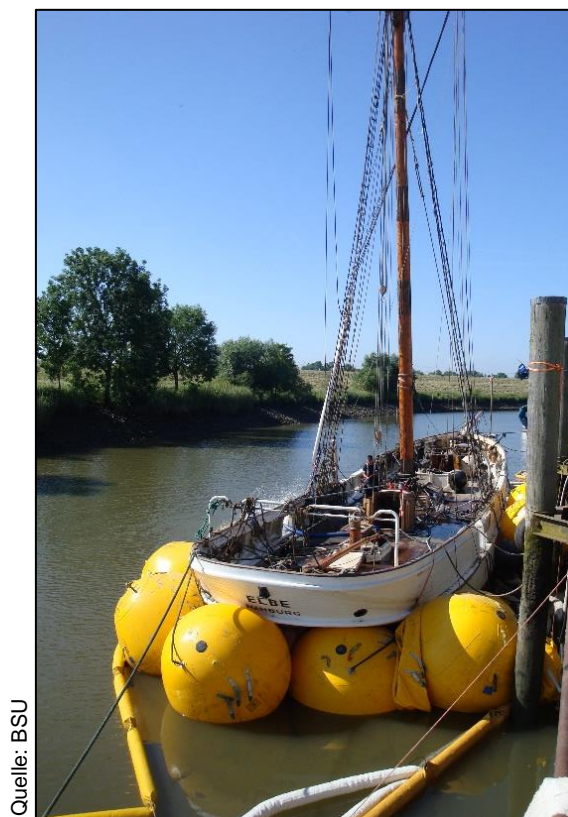
Abbildung 9: No.5 ELBE – aufgerichtet und schwimmend
