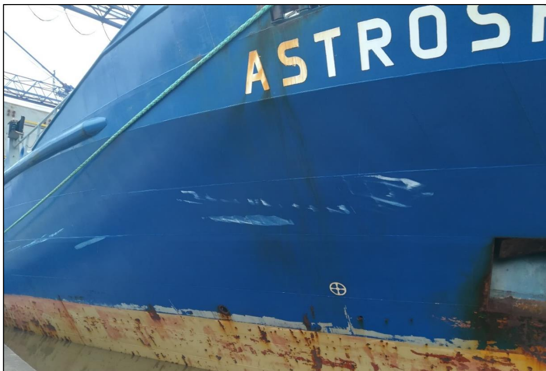
Abbildung 8: Schäden an der ASTROSPRINTER im Zoom
