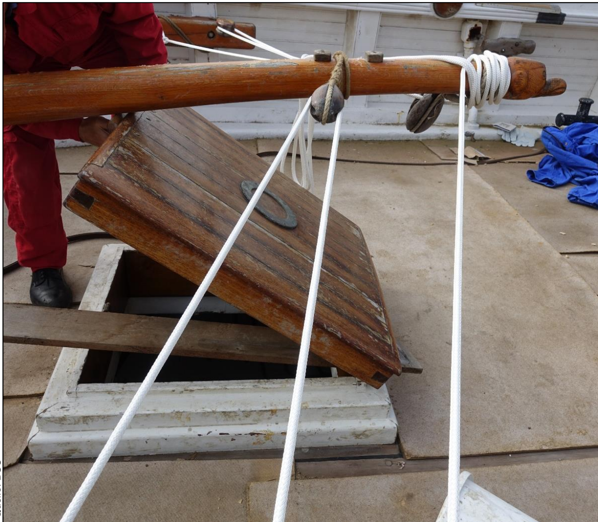
Abbildung 64: achtere Luke wird durch Pinne blockiert
