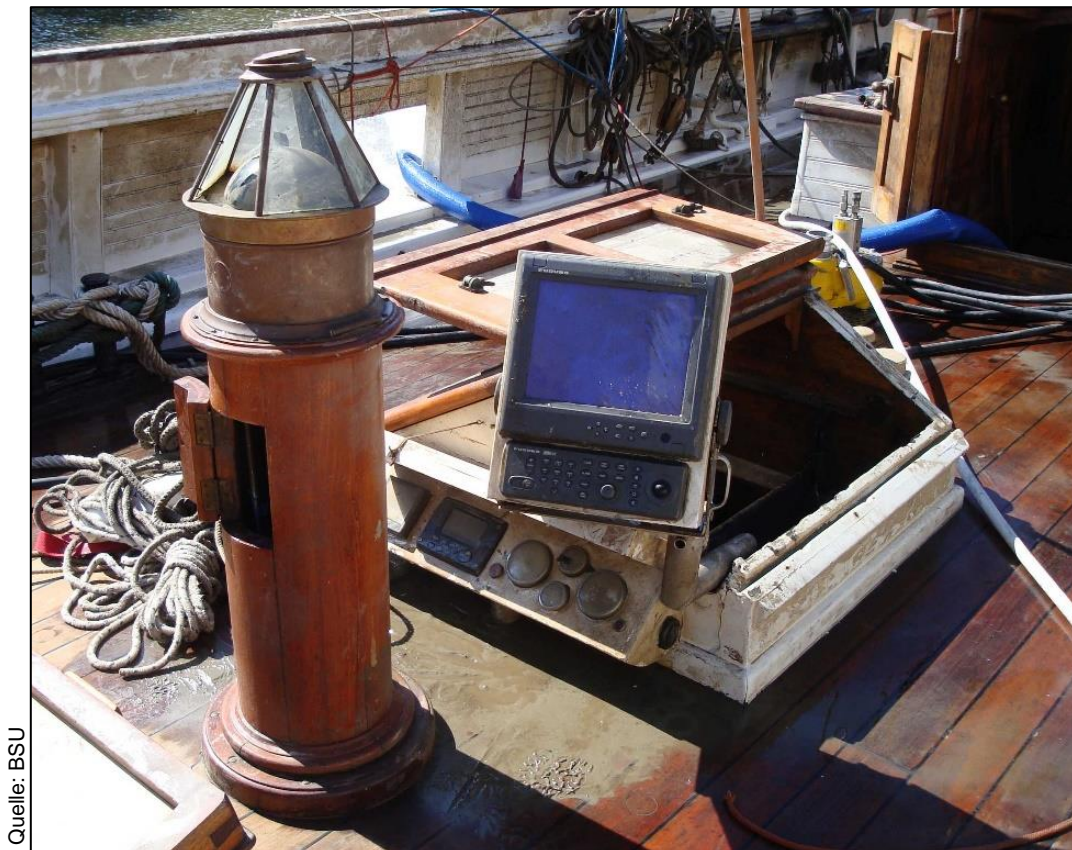
Abbildung 11: Kombiniertes Radar-Kartenplotter am Steuerstand
