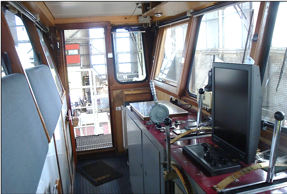
Abbildung 10: Fahrstand der HOCHDONN mit Hebelsteuerung (Blick in Richtung Brückentür)
