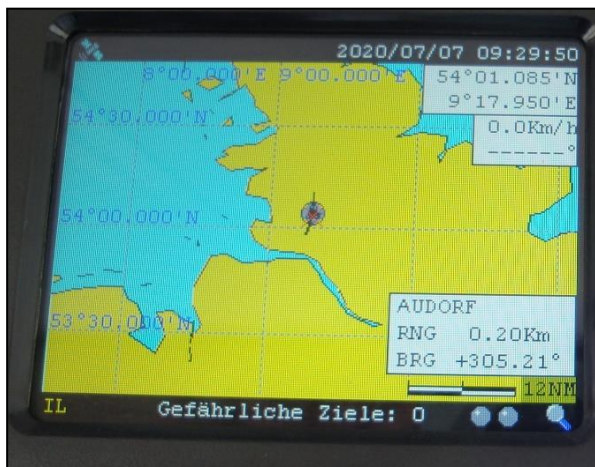
Abbildung 24: AIS-Display (Modus „Küstenansicht“) Abbildung 25: AIS-Display (Modus „Radaransicht“)
