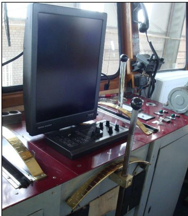
Abbildung 16: Radargerät (Fahrstand HOCHDONN)
