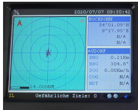
Abbildung 24: AIS-Display (Modus „Küstenansicht“) Abbildung 25: AIS-Display (Modus „Radaransicht“)
