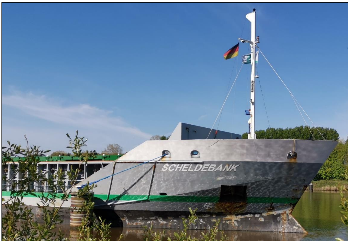
Abbildung 4: Farbabschürfungen am Steuerbordbug der SCHELDEBANK 14
