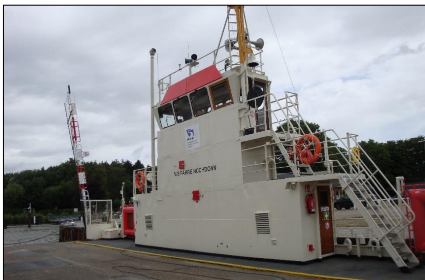
Abbildung 9: seitlicher Decksaufbau mit Brückenfahrstand
