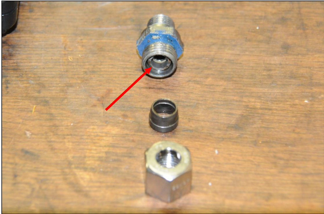
Abbildung 13: Schneidring 15 und innenliegendes Rohrfragment des Doppelnippels
