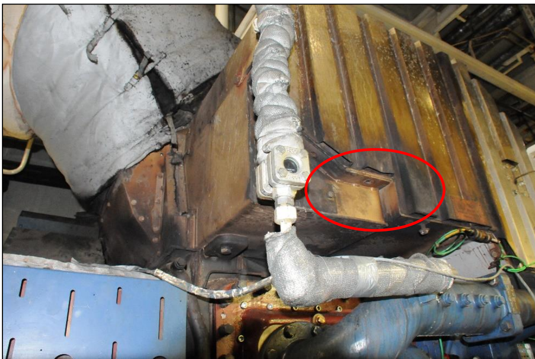
Abbildung 24: Brandspuren an der Außenseite des Turboladers (Abgasseite)
