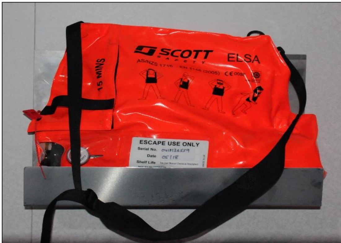
Abbildung 49: ELSA für die Rückzugssicherung des MR-Personals nach Entstehungsbrandbekämpfung
