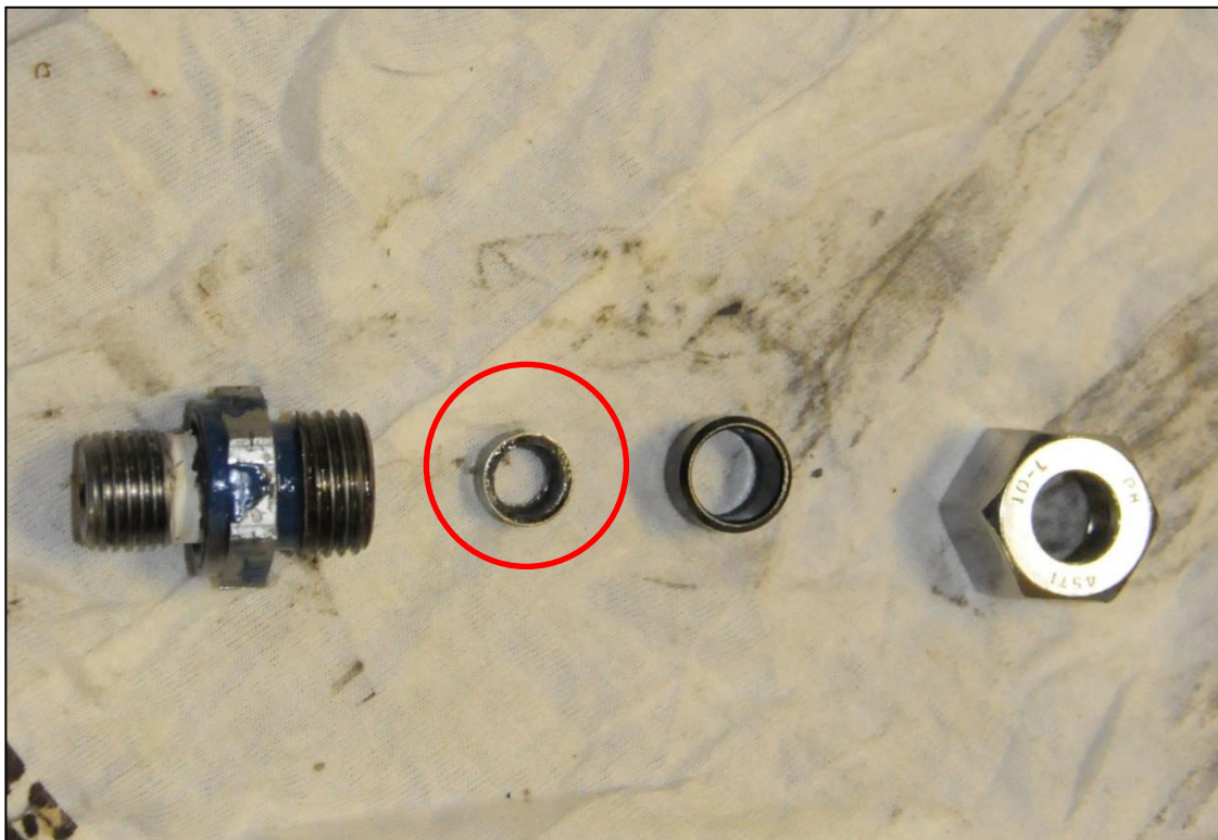
Abbildung 14: Verschraubung mit abgebrochenem Rohrleitungsstück
