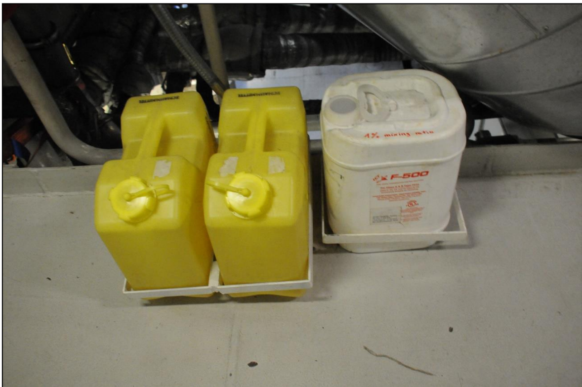
Abbildung 45: Zumischmöglichkeit von Schaum-/Netzmittel oder F-500 EA
