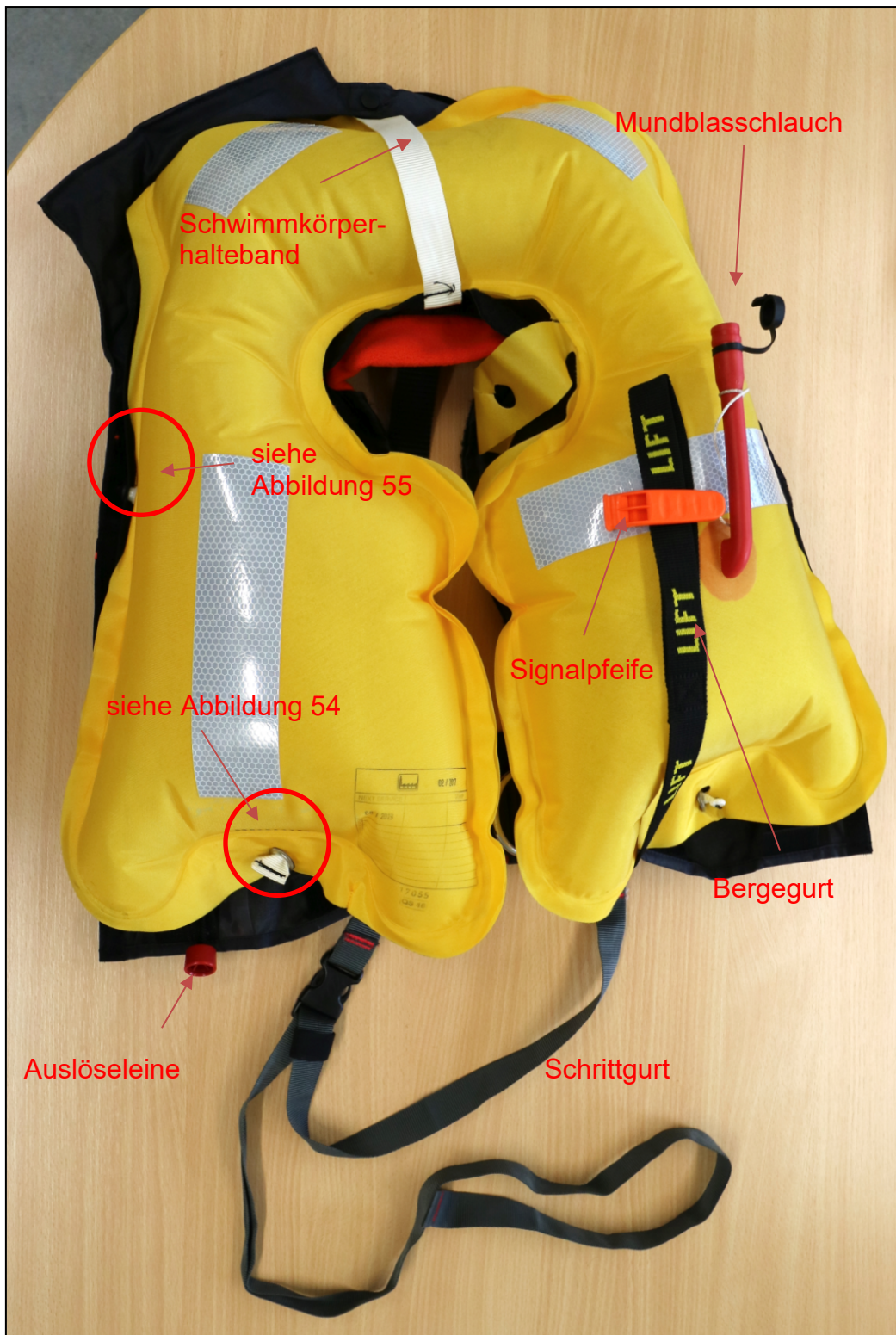
Abbildung 53: Ultra AX 150 mit Harness (Auftriebskörper aufgeblasen) 142
