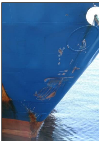
Abbildung 6: Beschädigung Vorschiff MS ELSE oberhalb der Wasserlinie
