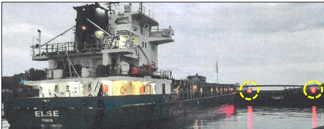
Abbildung 41: MS ELSE vor dem geschlossenen Schleusentor (rot leuchtende Warnlampen erkennbar) 68
