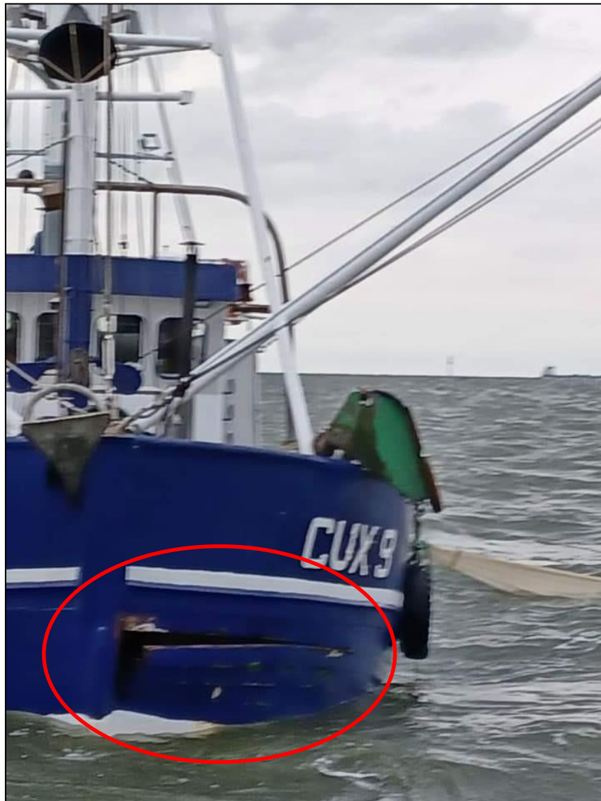
Abbildung 3: Die losen Planken am Bug der RAMONA 4
