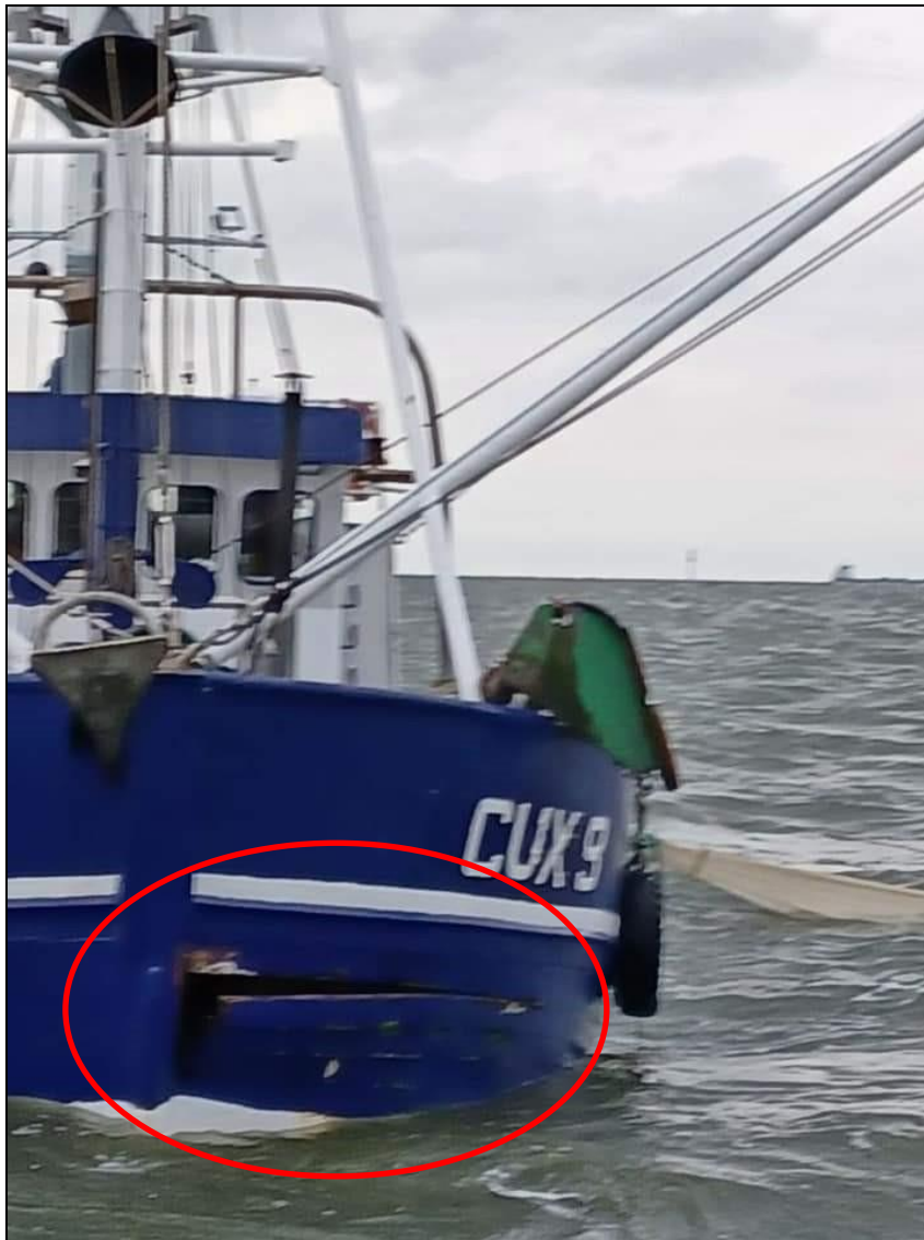
Abbildung 3: Die losen Planken am Bug der RAMONA 5
