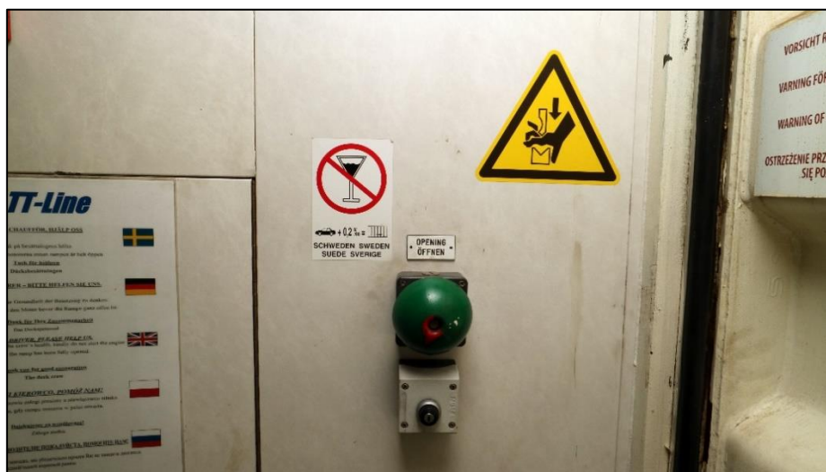
Abbildung 9: Taster zum Öffnen der Tür und Warnschild „Vorsicht Quetschgefahr“ 12
