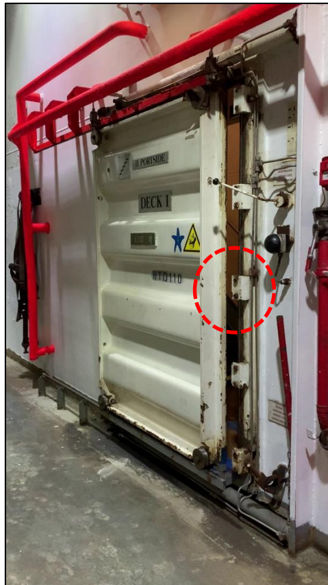
Abbildung 13: angenommener Ort, an dem sich die Verletzung ereignete 16 Darstellung hier an Hand der gegenüberliegenden Tür 110. Alle vier durch Passagiere nutzbaren Schiebetüren im unteren Fahrzeugdeck sind technisch vergleichbar.
