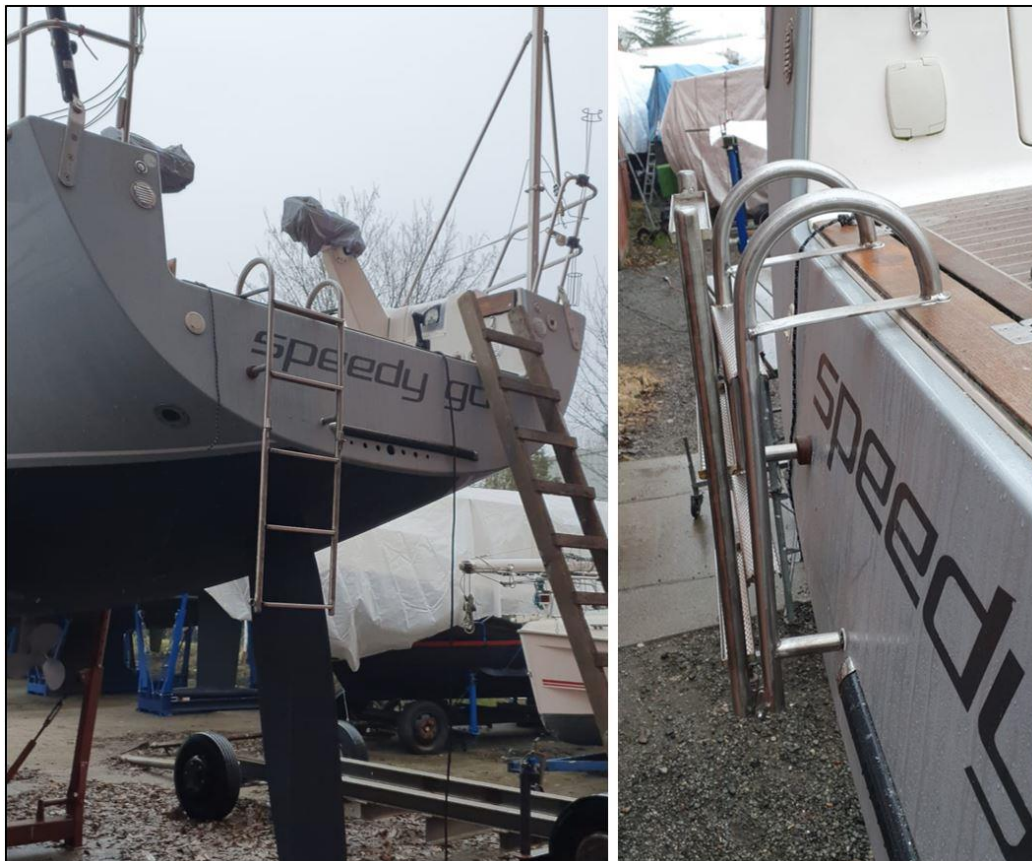
Abbildung 40: Festmontierte Badeleiter der SPEEDY GO nach Umbau 135
