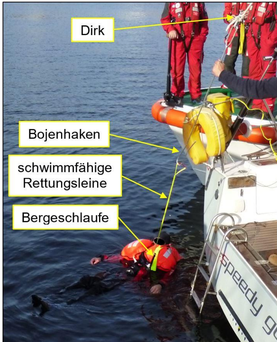
Abbildung 27: Rettung mittels an der Dirk befestigtem Bojenhaken 101
