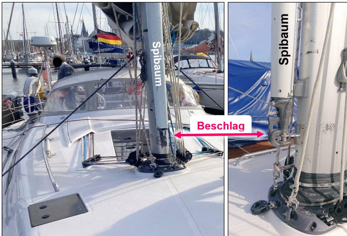
Abbildung 5: Am Mast befestigter Spinnakerbaum, wo sich die Schot verhakte 23
