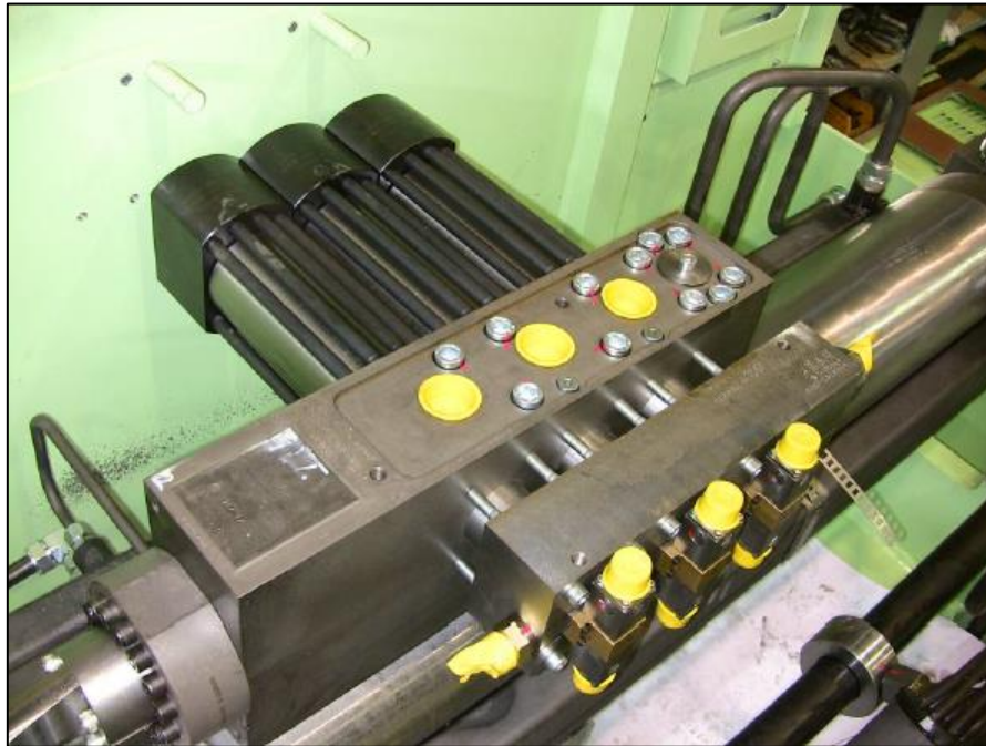
Abbildung 20: Foto einer ICU 74 (Während des Einbaus; verschiedene Anschlüsse noch mit gelben Plastikkappen bedeckt.)
