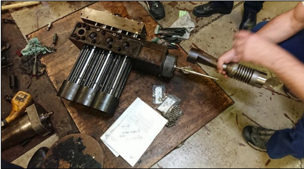
Abbildung 6: Ausgebaute und zerlegte ICU mit den drei Einspritzsteuerventilen (links) und dem Mengenkolben (in der Hand)
