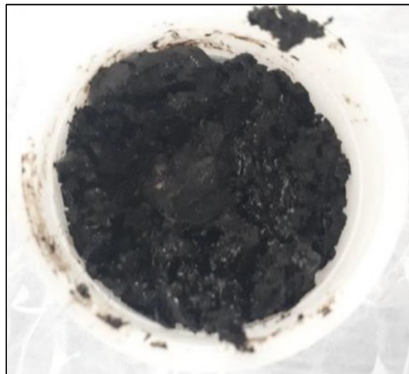
Abbildung 34: Teerartiger Rückstand in der Wiegeschale des Kraftstofflabors der TUHH
