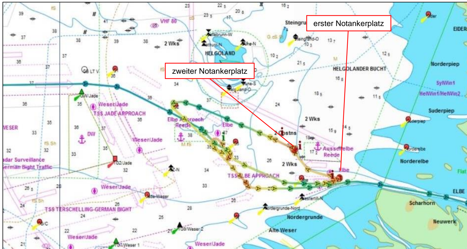
Abbildung 8: Track der EBBMA MAERSK, Unfall, Notankerplätze, Probefahrt 19
