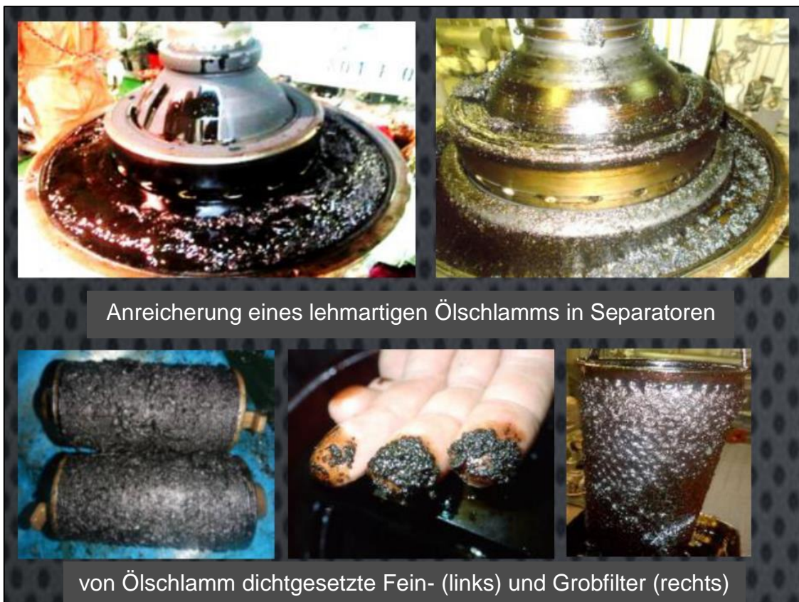
Abbildung 13: Ölschlamm in Separatoren und Filtern nach Kraftstoffmischung 48 (ausgefallene Asphaltene)
