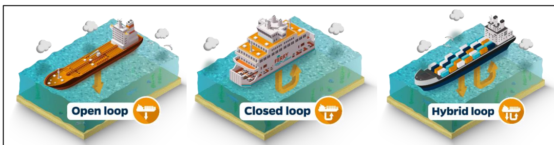
Abbildung 11: vereinfachte Visualisierungen der verschiedenen Scrubber-Arten 36
