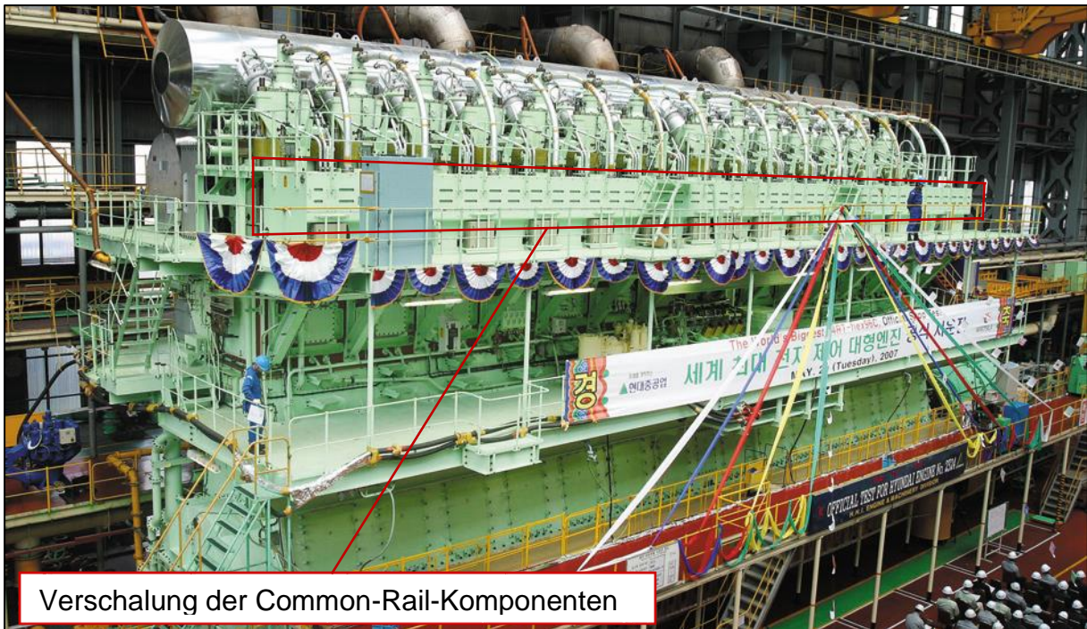
Abbildung 16: Hyundai Wärtsilä 14RT-flex96C (Lizenzbau) beim Testlauf 68 (Menschen als Größenvergleich)
