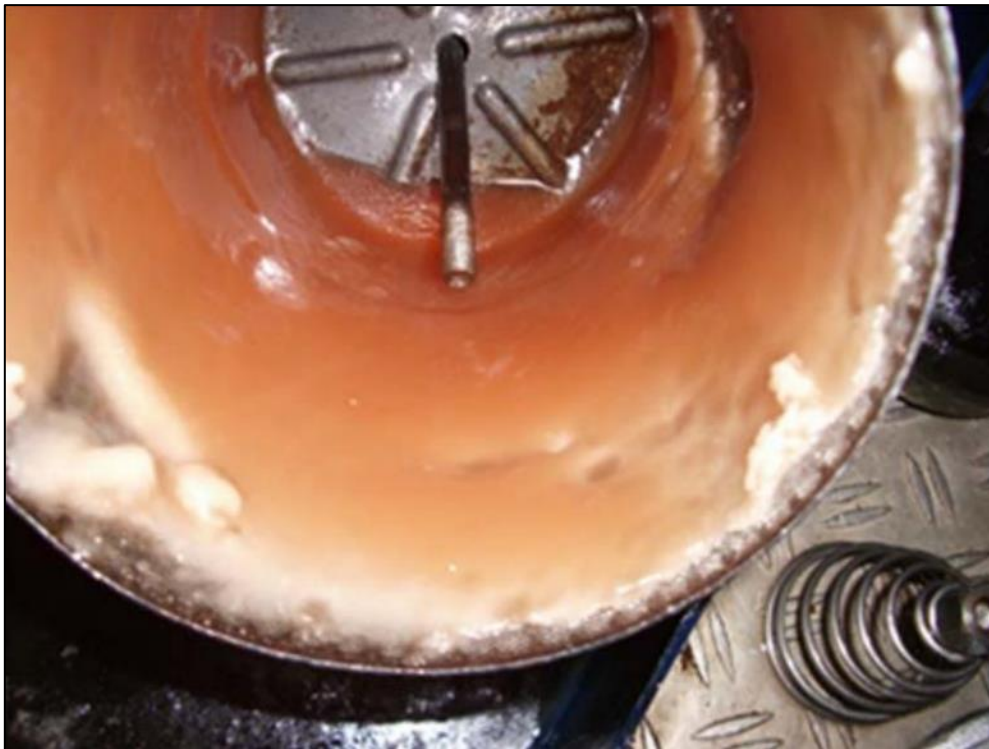
Abbildung 15: Mit erstarrtem Wachs dichtgesetzter Filter 57
