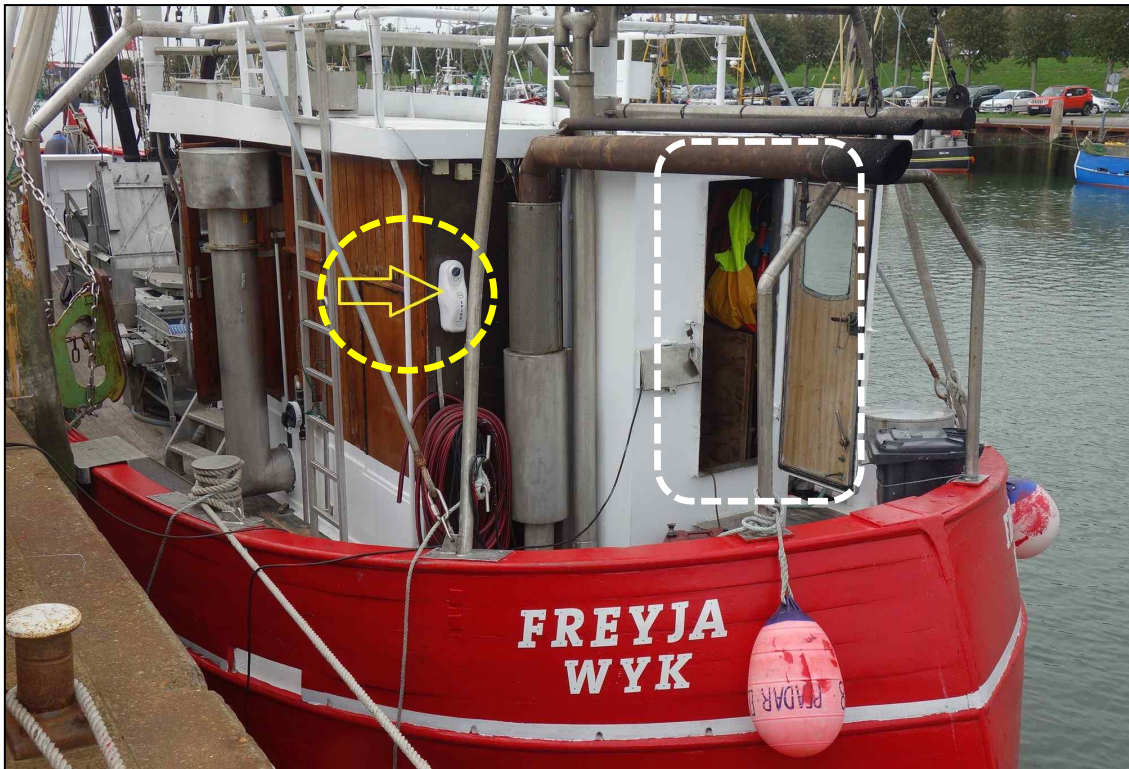
Abbildung 4: Zugang zum Maschinenraum im Heckbereich des Deckshauses der FREYJA und Montageposition der EPIRB 12
