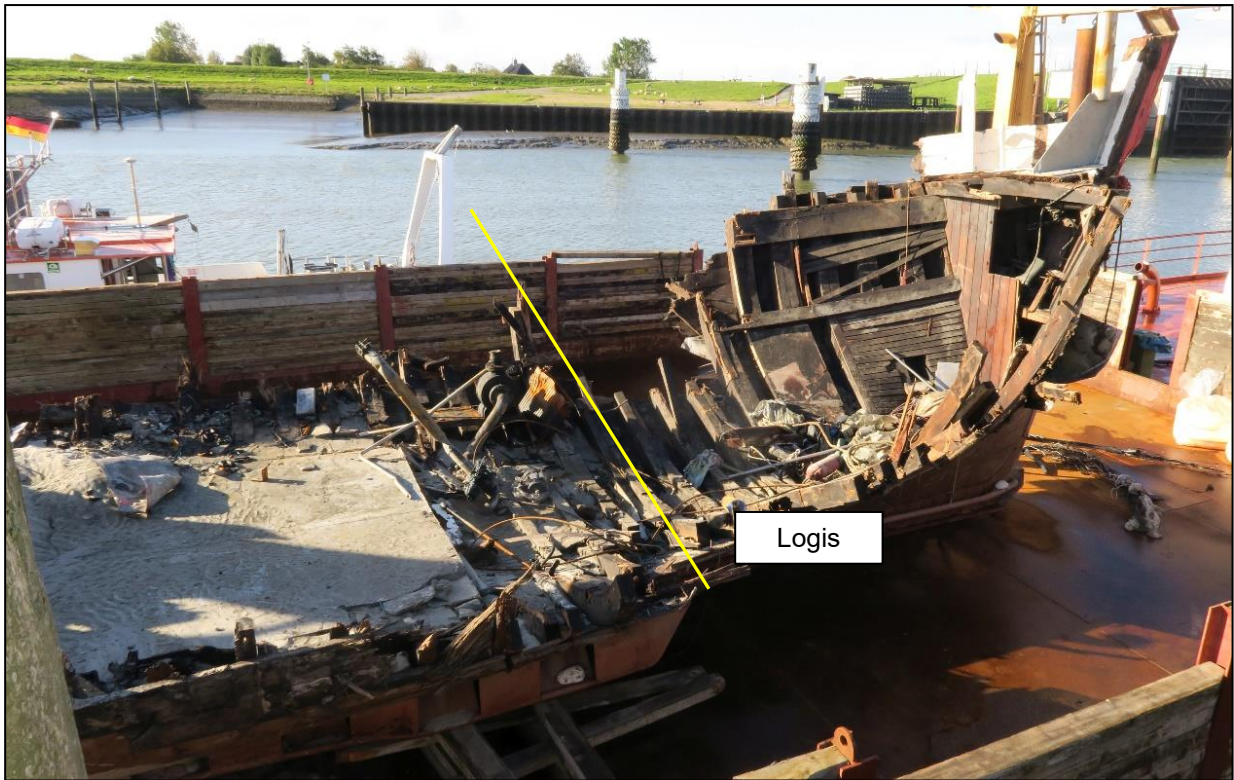
Abbildung 15: Fisch- und Pumpenraum sowie Logis
