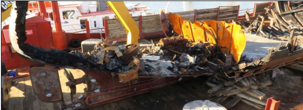
Abbildung 9: Ausgebranntes Wrack des Fischkutters FREYJA auf dem Deck der CATJAN (hier: achterer Fahrzeugteil mit Schiffsschraube und Überresten des Maschinenraums)
