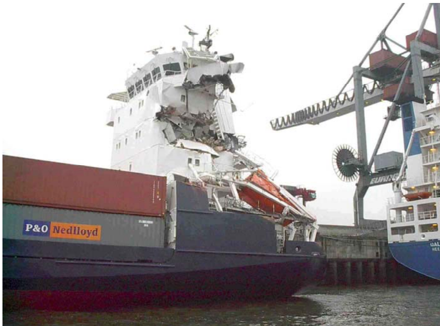
Schwerer Seeunfall mit Schäden an Unterkünften und tragenden Teilen Kollision MS HENNY / OOCL CANADA am 25.November2002 auf der Elbe
