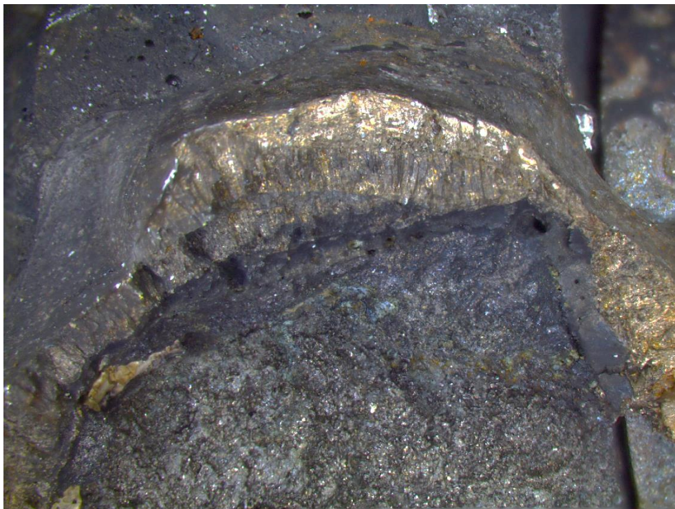
Bild 12: A: Schweißgut, B: Grundwerkstoff, C: Zwischenschicht
