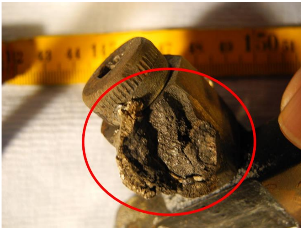
Bild 2: Bruchfläche – Seite am Drehgelenk
