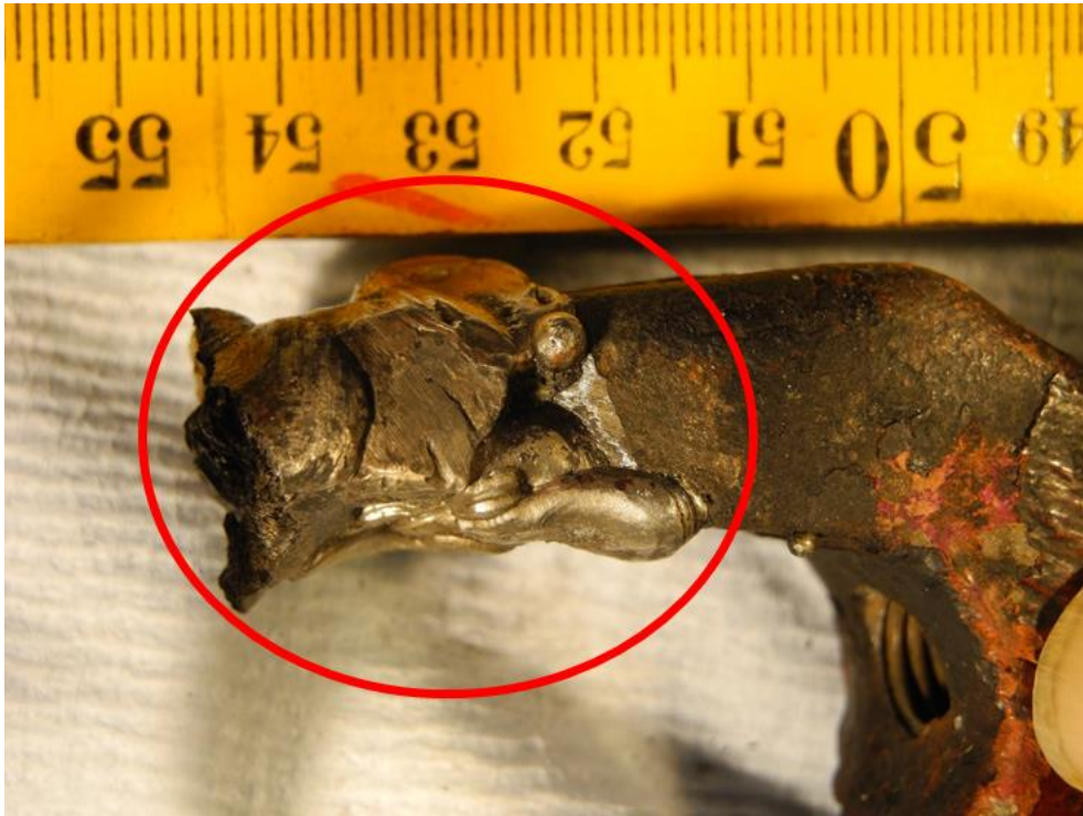
Bild 3: Makroaufnahme der Schweißung mit Lunker und Einbrandkerben
