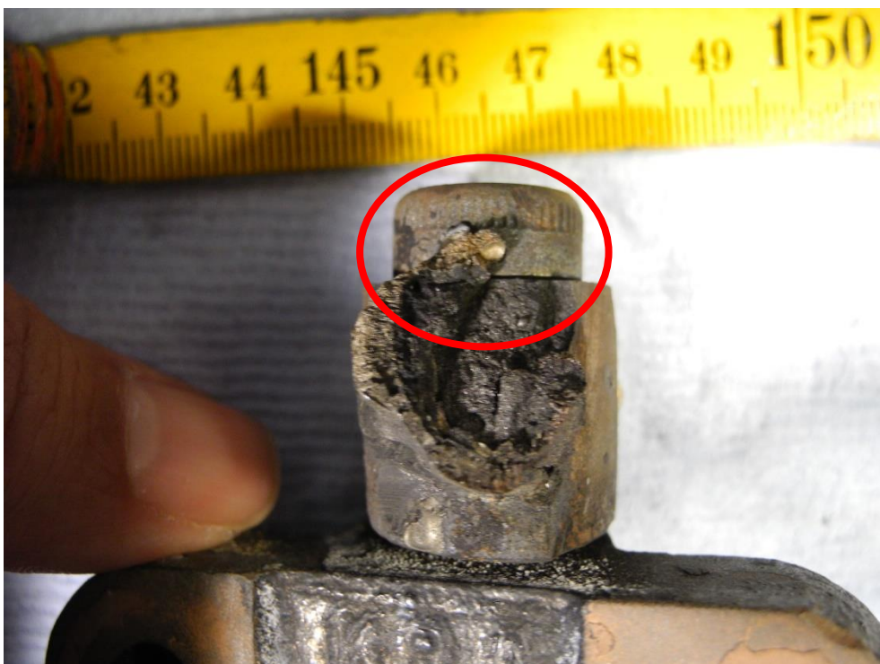
Bild 8: Kopf des Drehgelenkes „überschweißt“
