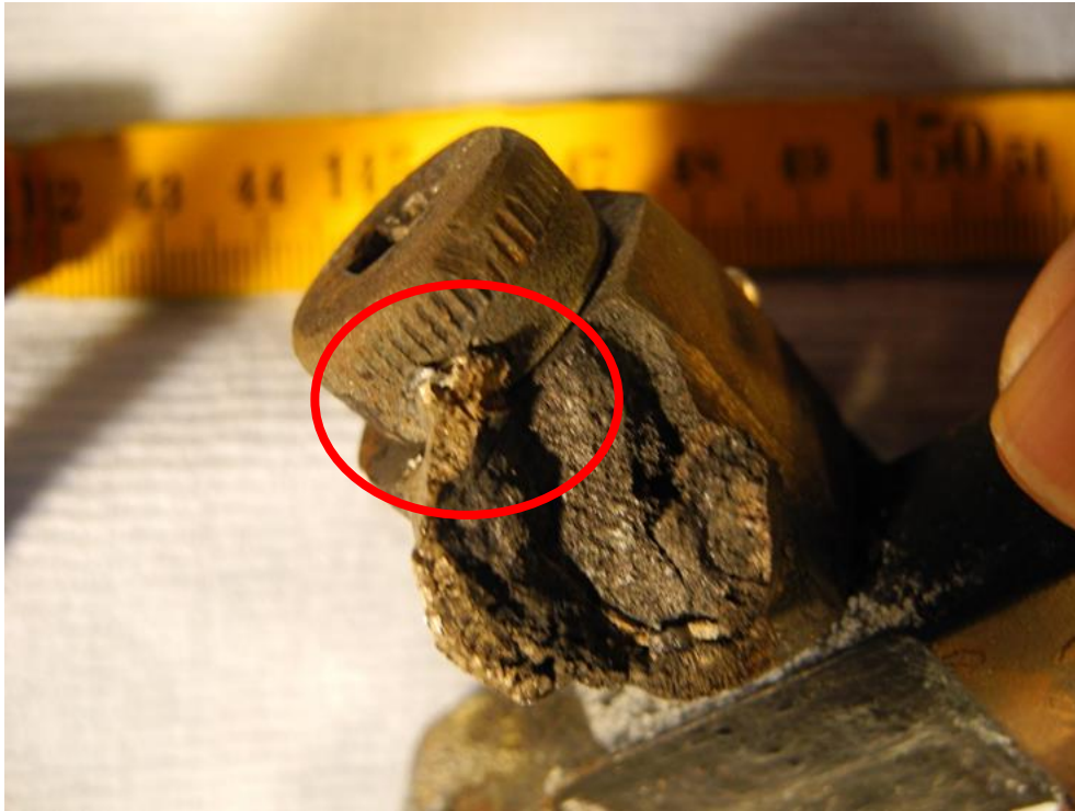
Bild 7: Kopf des Drehgelenkes „überschweißt“
